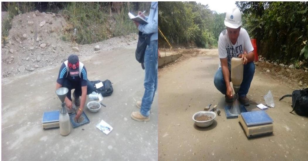
Figura 13. Toma de muestras para ensayo de densidades y humedades insitu (Fuente: Pasante)
