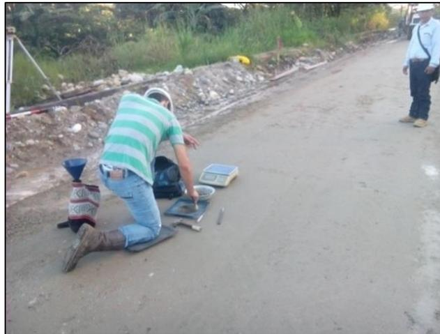
Figura 9. Toma de muestras in situ de humedades y densidades capa Subbase. (Fuente: Pasante)
