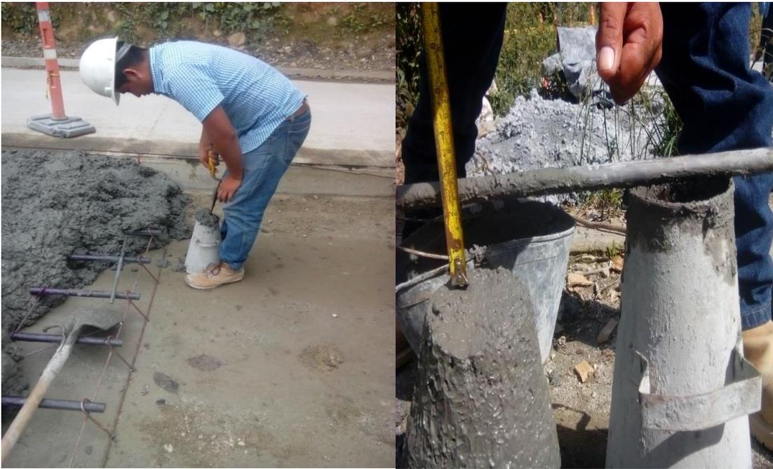
Figura 18. Ensayo de asentamiento de mezcla de concreto (SLUMP). (Fuente: Pasante)
