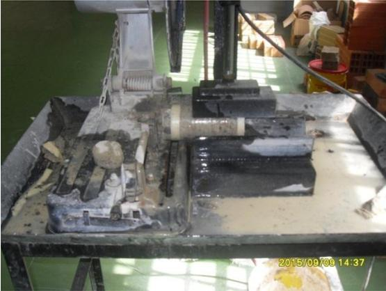
Nivelación de cilindros de concreto.
