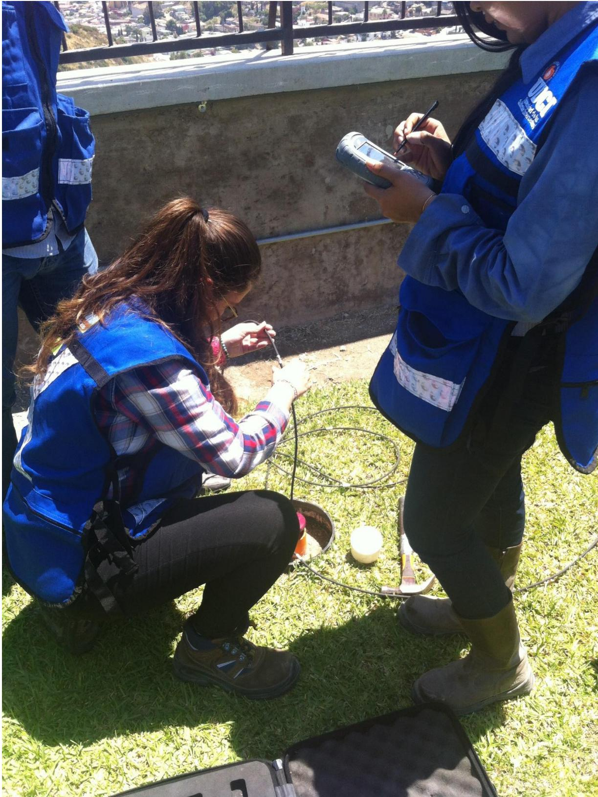
*Ilustración 56. Toma de Datos con sonda RST en Proyecto Rincón Toscano No. 1*
