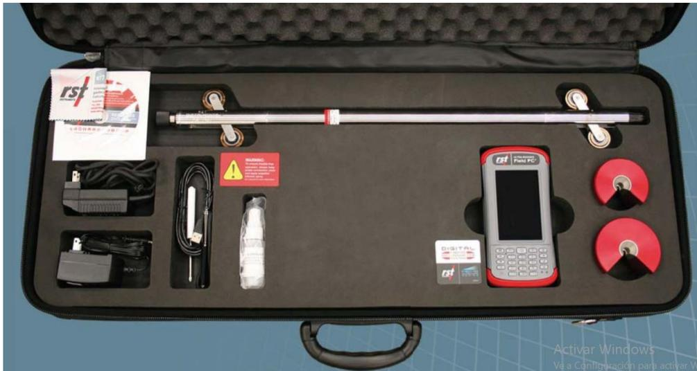
Ilustración 1. Sistema de Inclínometro digital MEMS ((Microelectromechanical Systems), marca RST
