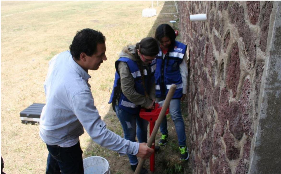
*Ilustración 47 Detección de tuberías con Depth Reading line tracer*
