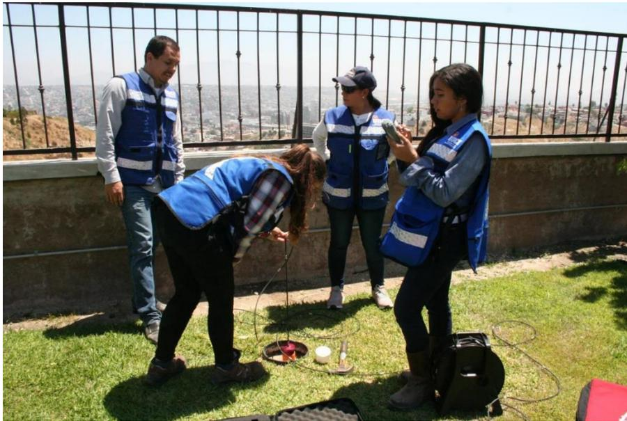
Ilustración 12. Retiro de Sonda Inclínométrica
