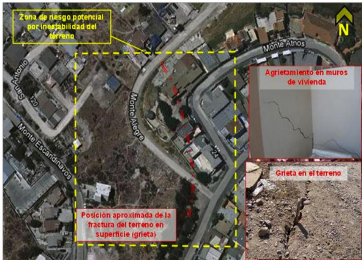
Figura 8. Vista en planta de la fractura del terreno y sus consecuencias.
