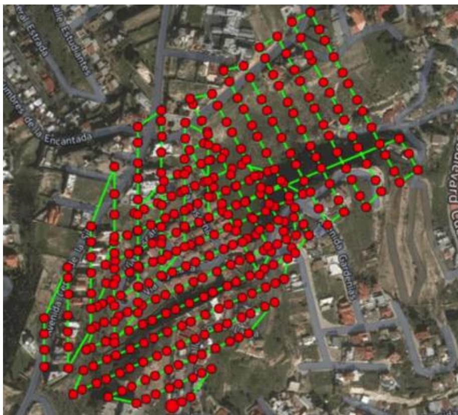
Figura 12. Plan de vuelo del Drone (líneas verdes) y posición de las fotografías (puntos rojos).
