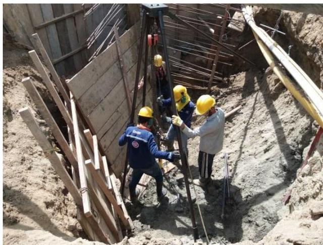
**Figura 21.** Ensayo de penetración estándar realizado en obra.
