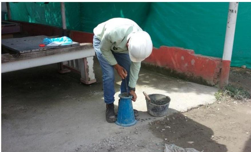
**Figura 53.** Prueba de asentamiento del concreto
