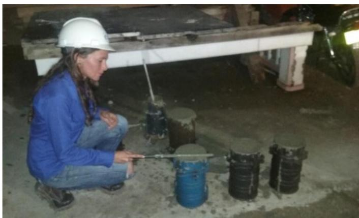
**Figura 54.**Elaboración de especímenes de concreto en obra
