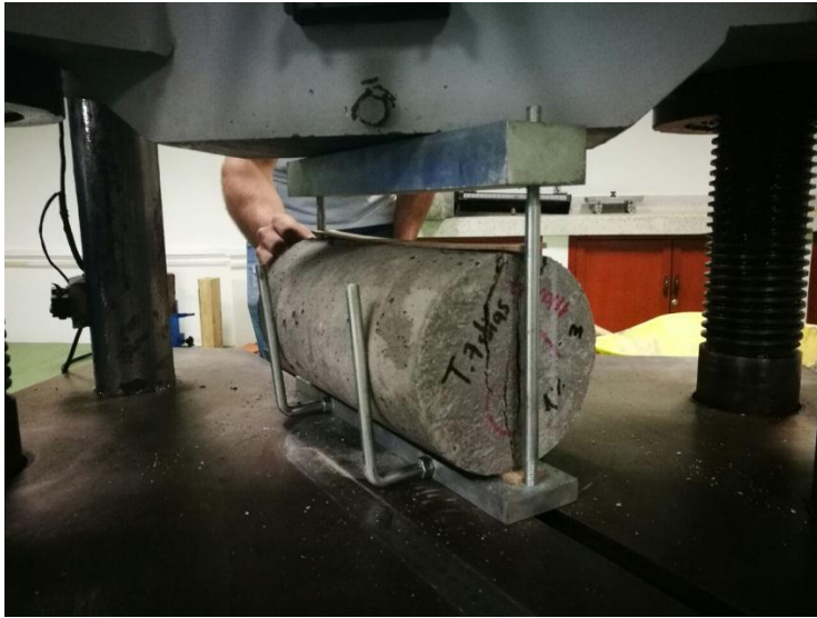
Figura 53. Falla presentada al realizar el ensayo de las probetas de Concreto 1%
