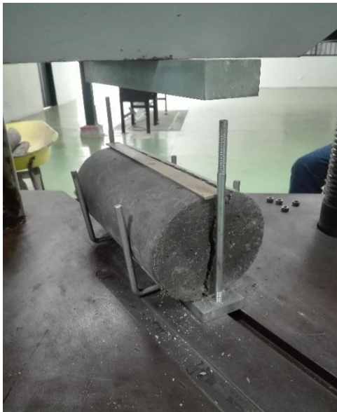
Figura 56. Cilindro de Concreto 1% de cabello humano
