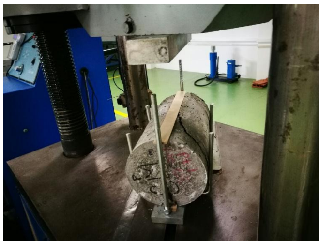
Figura 47. Concreto patrón al ser sometido a corte indirecto.
