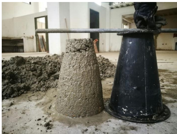
Figura 98. Slump del concreto adicionado con 3% de fibra de cabello humano.
