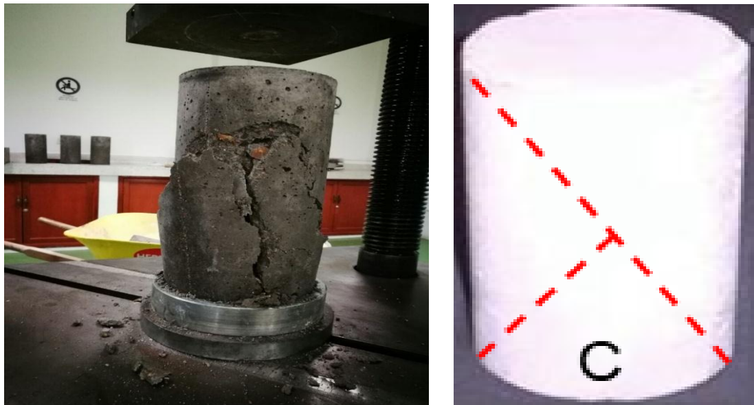
Figura 22. Falla del cilindro concreto patrón
