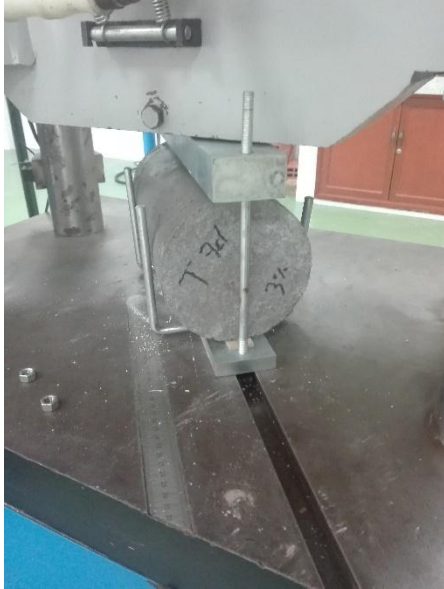
Figura 68. Ensayo a tracción del cilindro de concreto 3%
