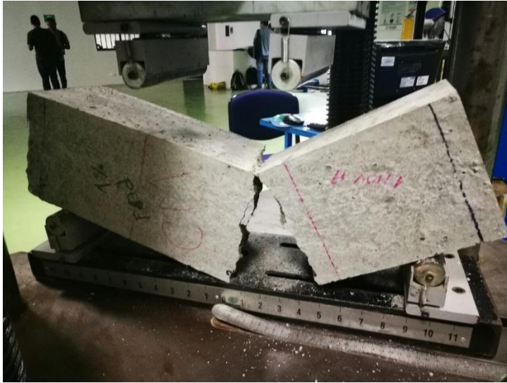
Figura 78. Falla de la viga de Concreto 1% de cabello humano.
