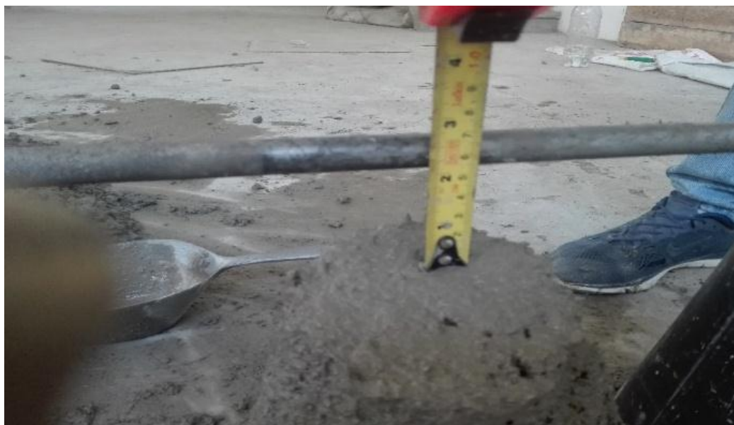
Figura 96. Slump del concreto adicionado con 1% de fibra de cabello humano.
