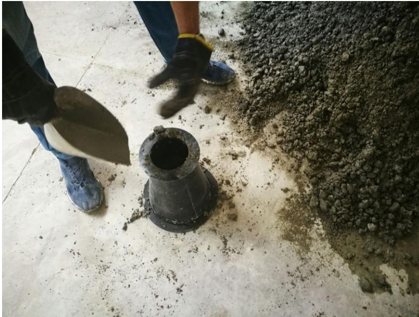
Figura 94. Adición de la mezcla al cono
