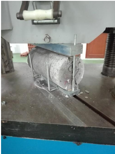
Figura 50. Concreto patrón cilindro al ser sometido a corte indirecto.
