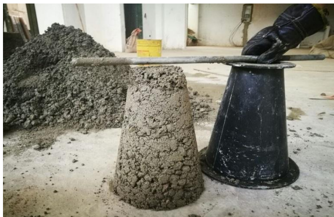
Figura 95. Slump del concreto patrón
