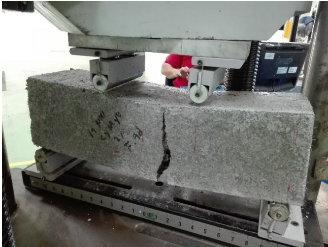
Figura 84. Falla presentada en la viga Concreto 2%
