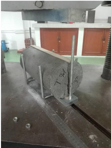
Figura 65. Falla del Cilindro de Concreto con 3% de cabello humano
