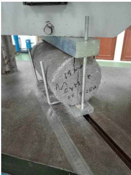
Figura 62. Cilindro de Concreto con 2% de cabello humano
