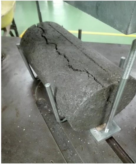
Figura 59. Cilindro de Concreto con adición del 2% de cabello humano
