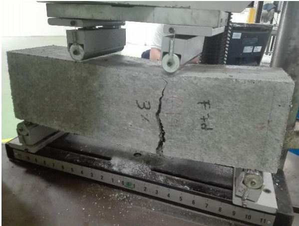
Figura 90. Falla de la viga de Concreto 3%
