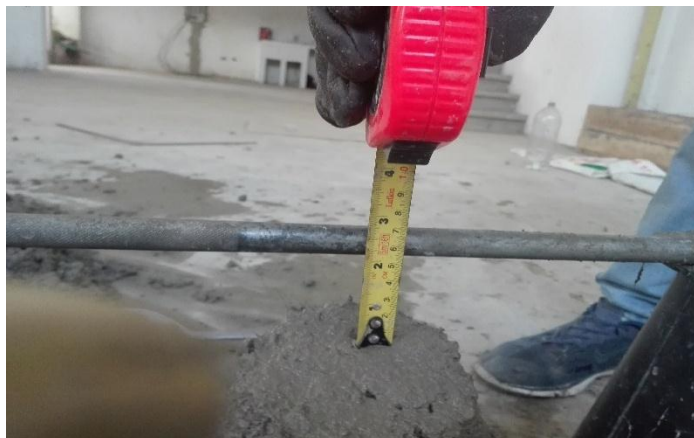
Figura 97. Slump del concreto adicionado con 2% de fibra de cabello humano.
