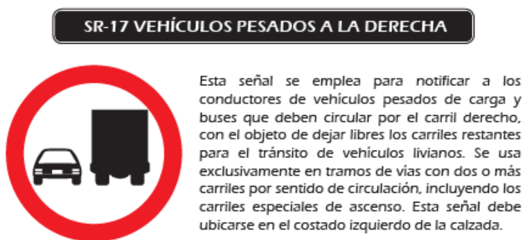
Figura 30. Especificación de señal SR-17.
