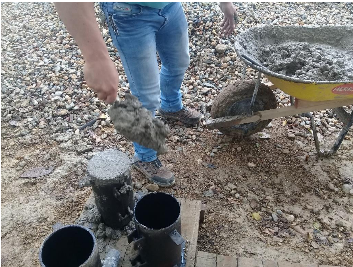
Figura 40. Elaboración de muestras de concreto por interventor.
