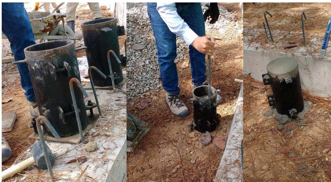
Figura 21. Toma de muestras de concreto por parte del contratista.
