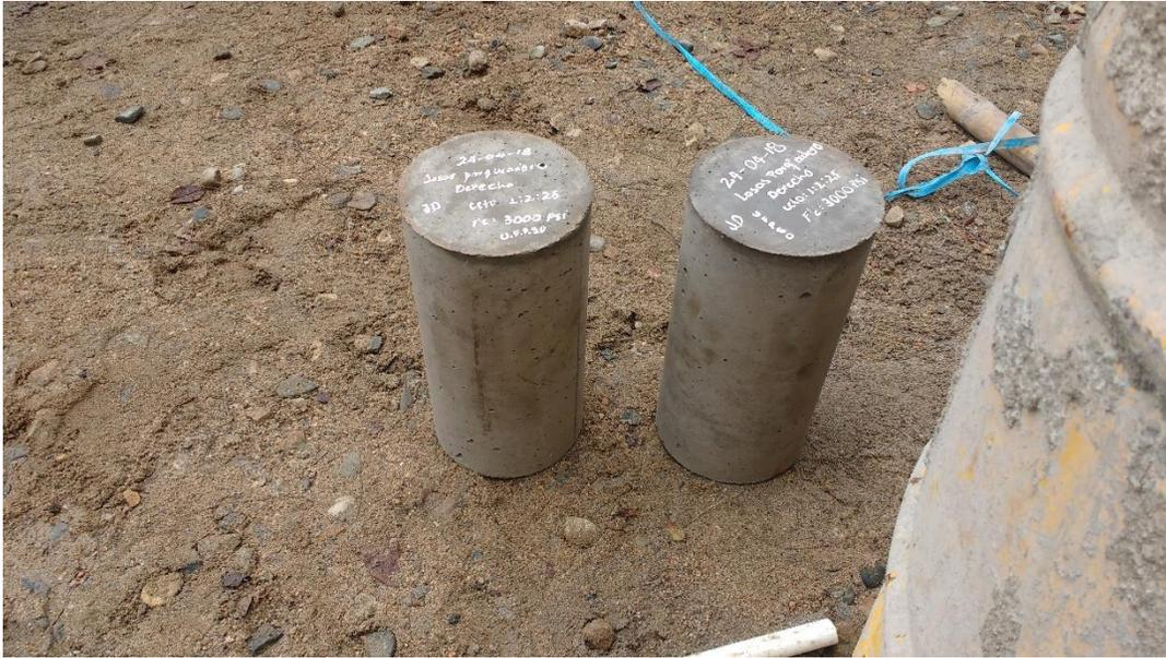
Figura 24. Etiquetado de las muestras de concreto.
