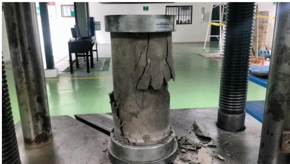
Figura 25. Falla de muestra de concreto después del ensayo a compresión.
