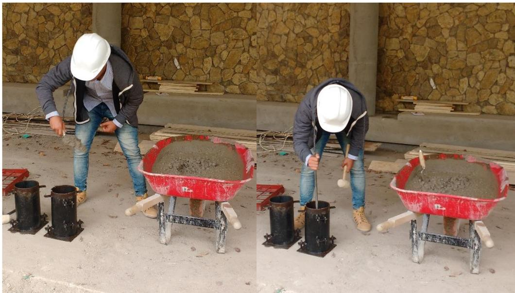
Figura 22. Toma de muestras de concreto por parte de la supervisión.
