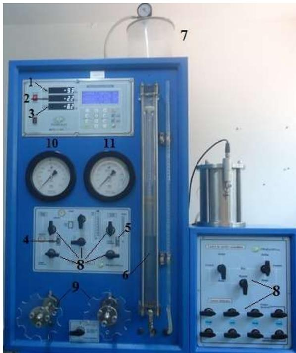
Figura 77. Unidad triaxial automática
