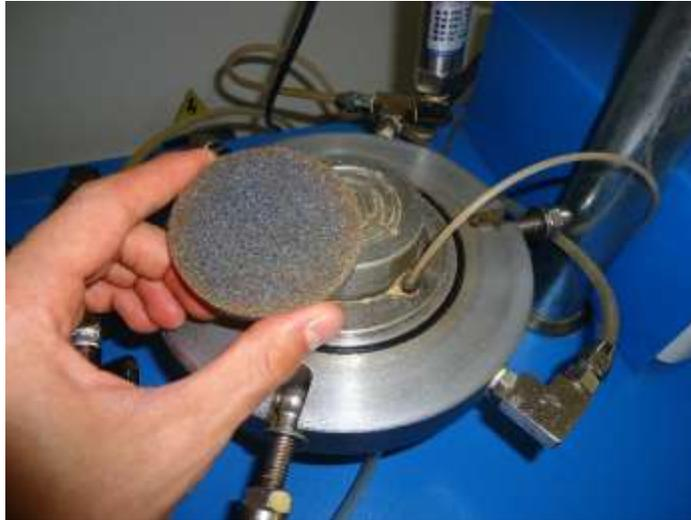
Figura 110. Posicionamiento de piedra porosa en pedestal
