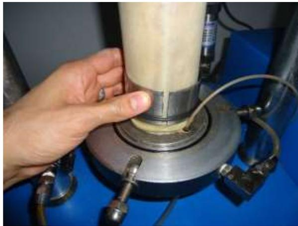
Figura 122. Colocador de anillo O-ring en parte inferior de la muestra
