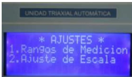
Figura 81. Menú de ajustes Unidad Triaxial Automática
