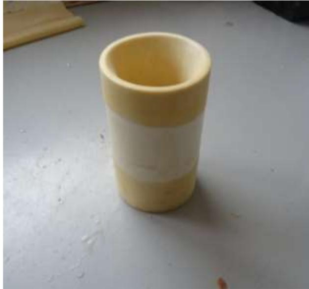
Figura 115. Membrana de látex colocada en su accesorio
