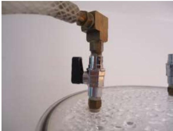
Figura 105. Válvula del tanque de agua para aplicación de vacío
