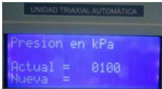
Figura 84. Submenú de cambio de presiones de la unidad triaxial automática
