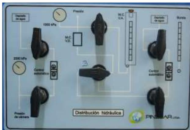
Figura 89. Válvulas en posición incorrecta
