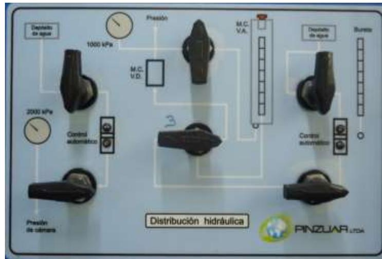
Figura 108. Válvulas de tanque de almacenamiento cerradas
