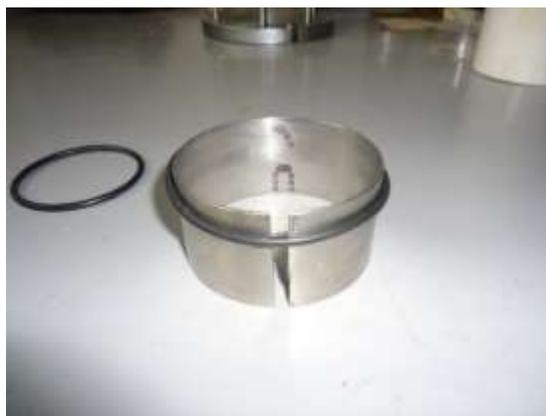
Figura 121. Anillo O-ring colocado en su herramienta
