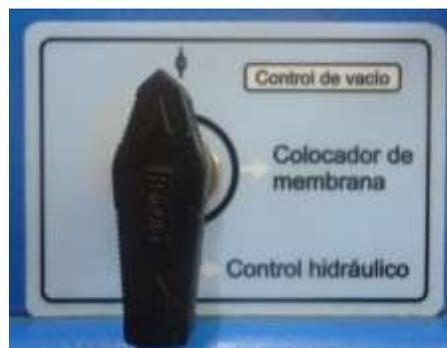
Figura 94. Válvula de control de vacío
