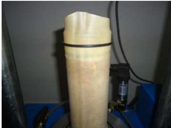
Figura 125. Anillo O-ring superior en muestra
