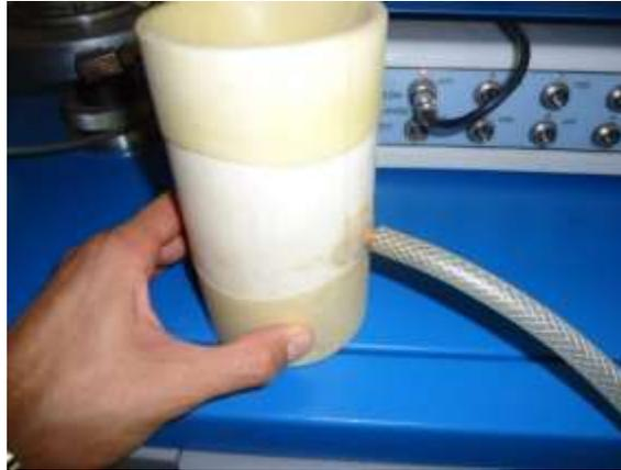
Figura 117. Accesorio colocador de membrana conectado al tubo de aplicación de vacíos
