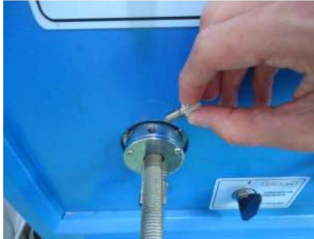
Figura 97. Tornillo de seguridad de bomba hidráulica
