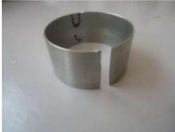
Figura 73. Herramienta para colocación de anillos de sellado
