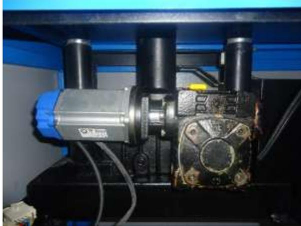
Figura 47. Servomotor
