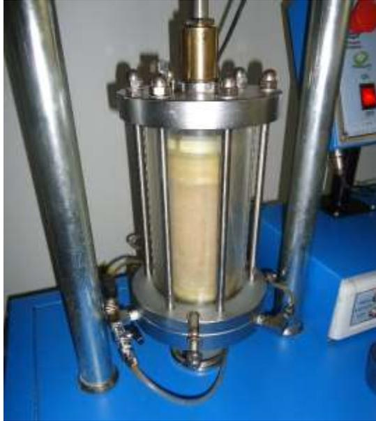
Figura 127. Montaje de celda triaxial con espécimen para ensayo
