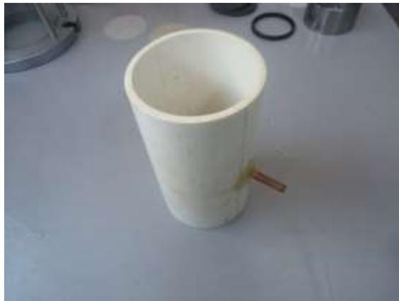
Figura 72. Herramienta para colocación de membrana
