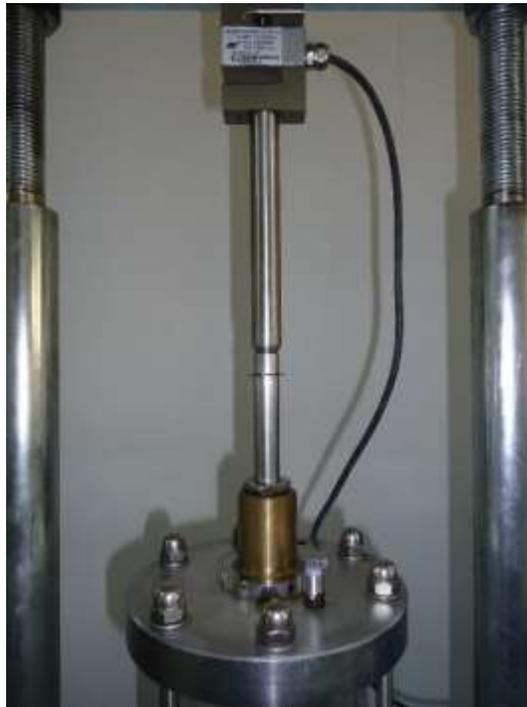
Figura 128. Marco de carga alineado con el pisto de carga de la celda triaxial
