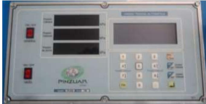
Figura 78. Tablero de indicación de la Unidad triaxial automática
