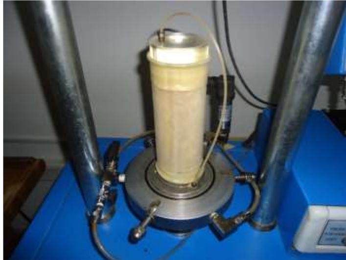
Figura 126. Posición de membrana y conducto de cabezal en correcta posición
