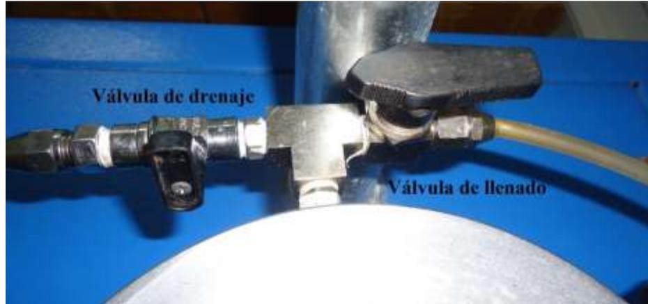
Figura 130. Válvulas de drenaje y llenado de celda triaxial
