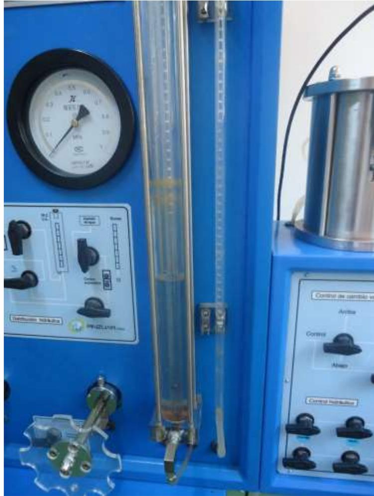
Figura 159. Bureta para medición de cambio de volumen
