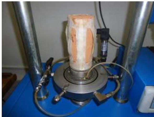
Figura 113. Muestra de suelo con papel filtro lateral ubicado en pedestal
