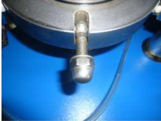
Figura 71. Perno ubicado en el pedestal
