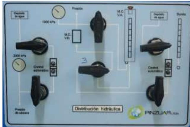
Figura 96. Válvulas en posición para cargar bomba hidráulica
