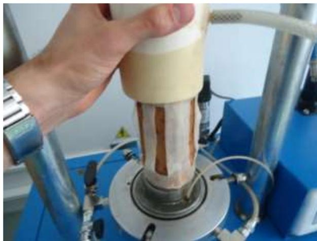
Figura 118. Colocación de membrana a muestra de suelo
