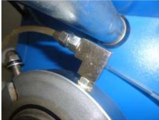
Figura 61. Presión y drenaje de cabezal
