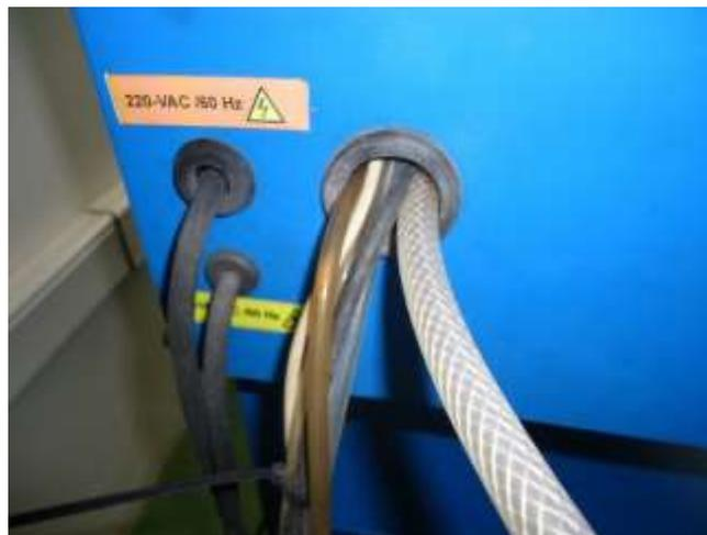
Figura 116. Tubo de aplicación de vacíos a membrana (tubo del extremo derecho)
