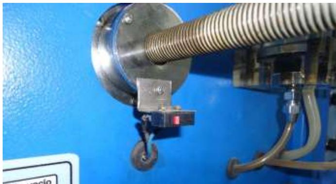
Figura 98. Interruptor de emergencia para las perillas de presión
