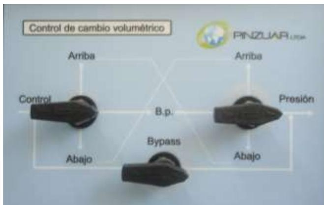
Figura 91. Válvulas de control de cambio volumétrico
