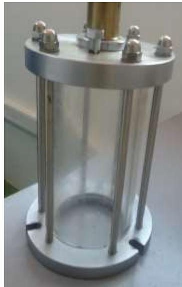
Figura 58. Celda acrílica
