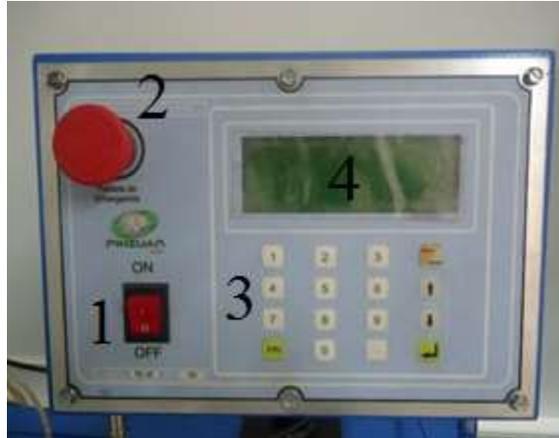
Figura 48. Panel de control del marco de carga
