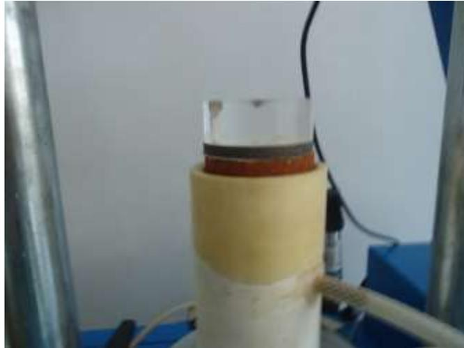
Figura 119. Cabezal colocado en la muestra de suelo
