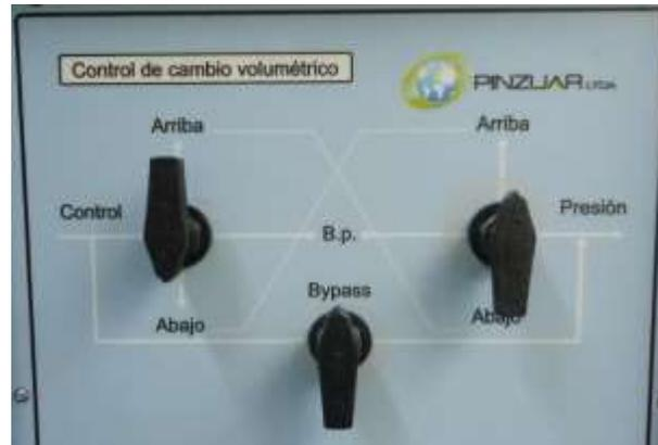
Figura 93. Válvulas en correcta posición para medición de cambio de volumen. Posición 2: entrada de presión por abajo y salida de presión por arriba
