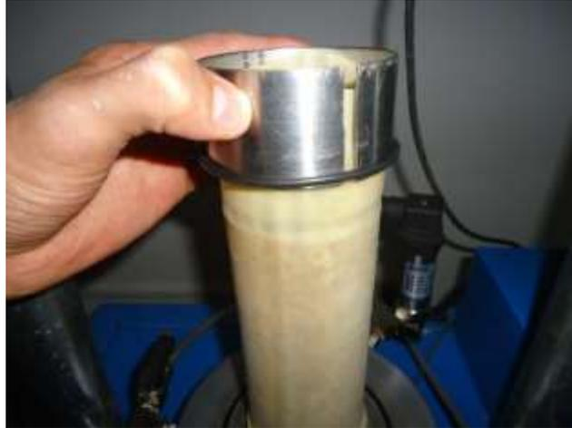
Figura 124. Colocador de anillo O-ring en parte superior de la muestra
