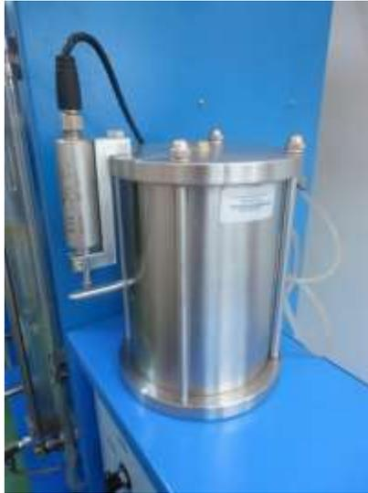
Figura 102. Unidad de cambio de volumen automático
