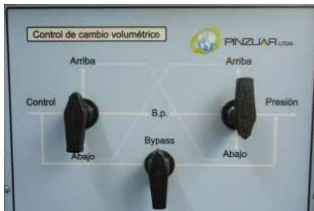
Figura 92. Válvulas en correcta posición para medición de cambio de volumen. Posición 1: entrada de presión por arriba y salida de presión por abajo.
