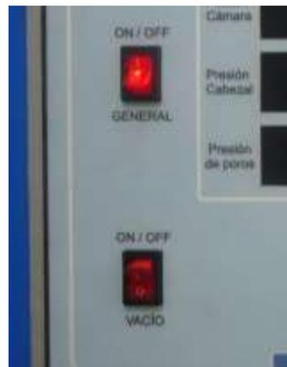
Figura 101. Interruptor de bomba de vacíos
