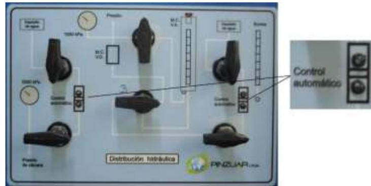
Figura 86. Bombillos LED del control automático de presiones
