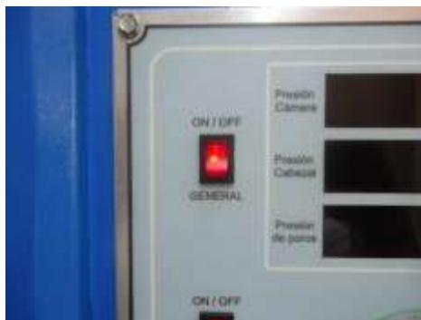
Figura 76. Interruptor de encendido y apagado Unidad Triaxial
