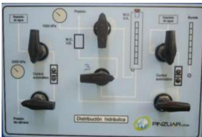
Figura 85. Válvulas de distribución hidráulica
