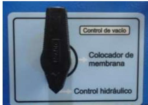
Figura 107. Válvula de vacíos en posición para tanque de almacenamiento de agua
