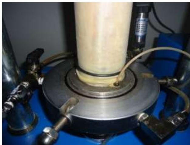
Figura 123. Anillo O-ring inferior en muestra
