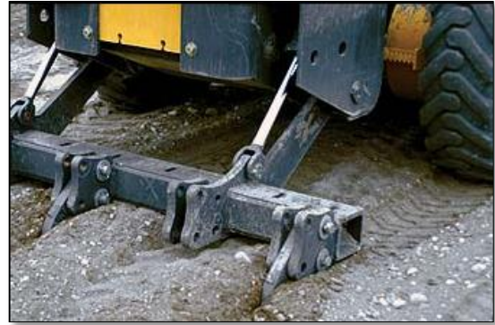
Figura 6. Escarificación del terreno. Fuente: Caterpillar (2018).
