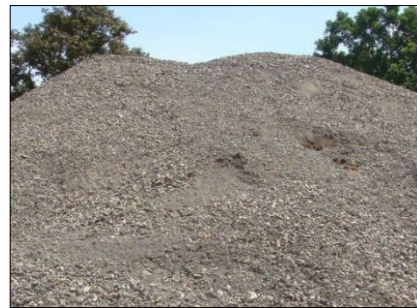
Figura 8. Material que conforma la sub base granular. Fuente: Manufacturer (2015).
