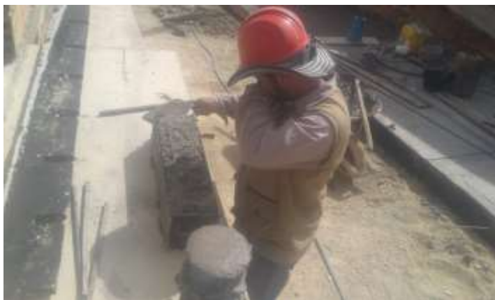
Figura 60. Preparación de ensayos de compresión a cilindros de concreto y flexión, pavimentación Brisas del Polaco.
