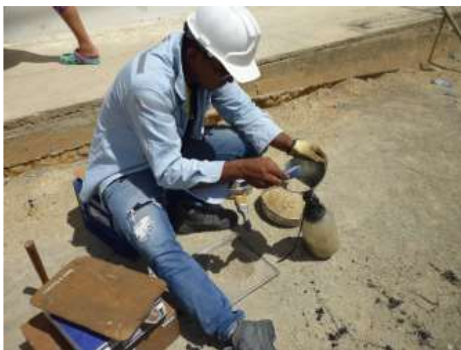
Figura 61. Ensayo de densidades, pavimentación Brisas del Polaco.
