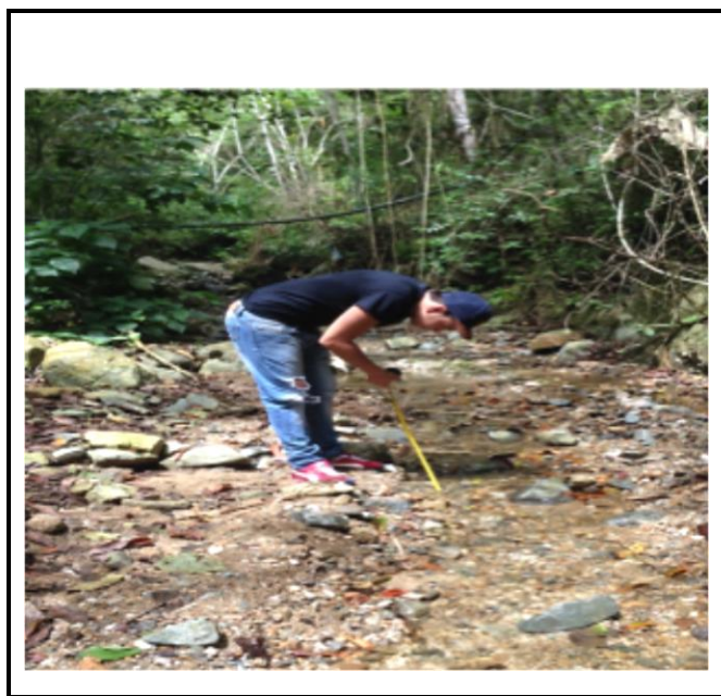
Fotografía 18. Medición de las profundidades de una sección transversal en la Quebrada La Toma.
