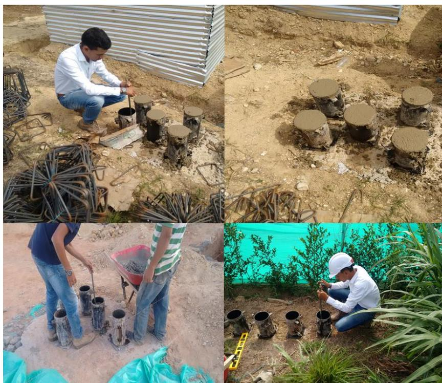
**Figura 23. Realización de cilindros de concreto.**
