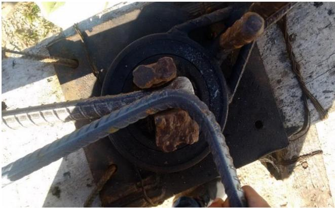
**Figura 28. Prueba de figuración al acero.**
