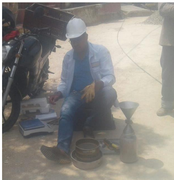
Figura 10. Ensayo de densidad para subbase granular Tramo Santa Clara – Peso de la muestra.
