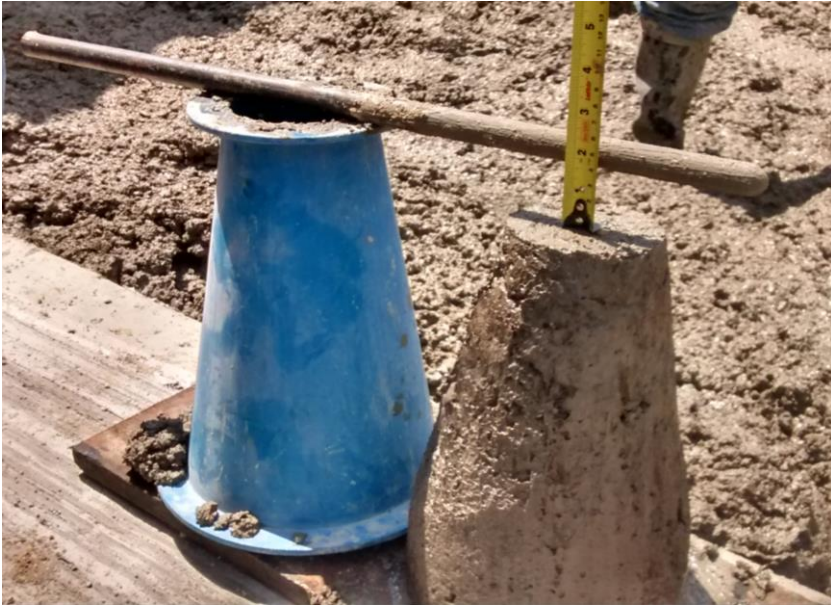
Figura 13. Ensayo de asentamiento (slump) de la mezcla de concreto fresco 1.
