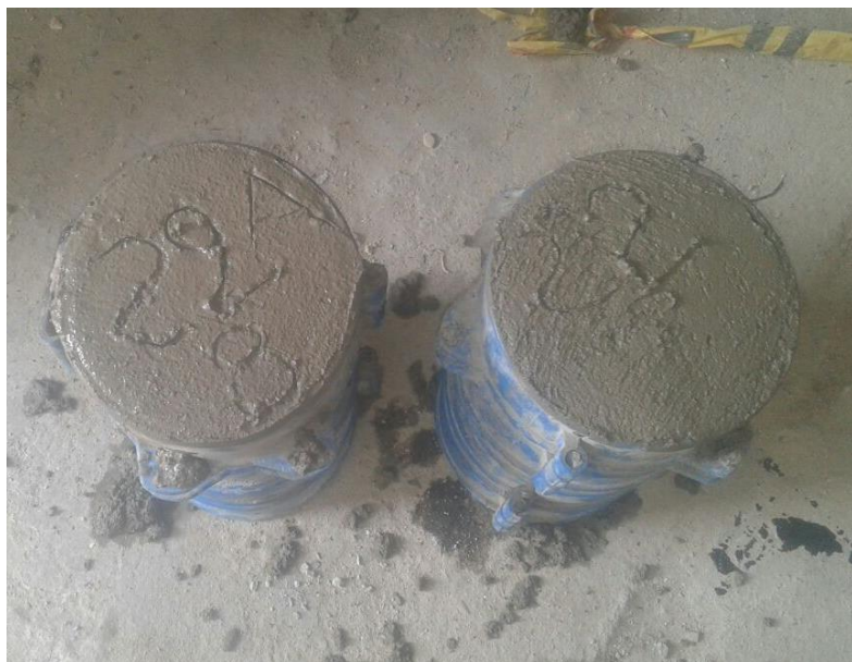
Figura 11. Toma de cilindros de concreto para ser fallados a compresión en laboratorio.
