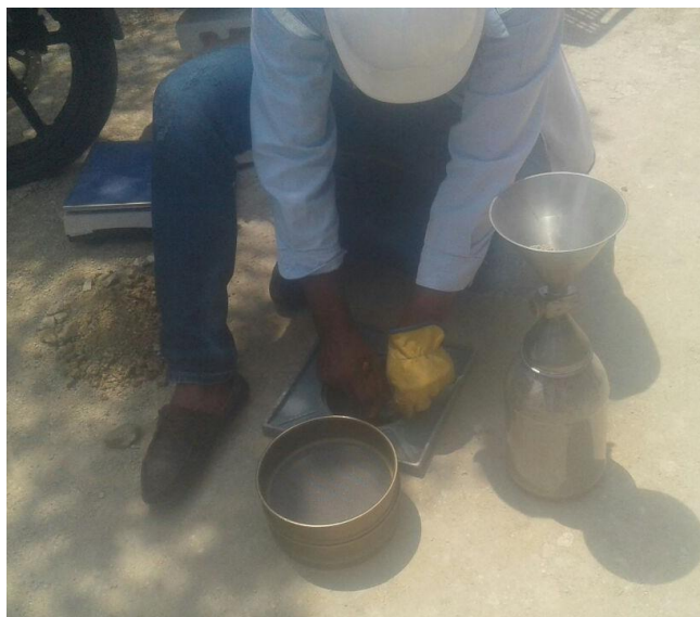
Figura 9. Ensayo de densidad para subbase granular Tramo Santa Clara – Toma de muestra.
