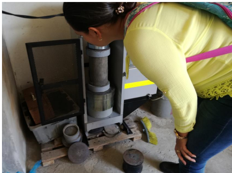
Figura 12. Fallo a compresión de cilindros de concreto en laboratorio.
