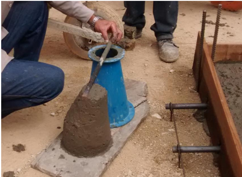
Figura 14. Ensayo de asentamiento (slump) de la mezcla de concreto fresca 2
