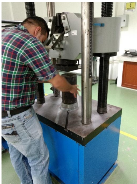
Figura 25. Elaboración ensayos de compresión del concreto
