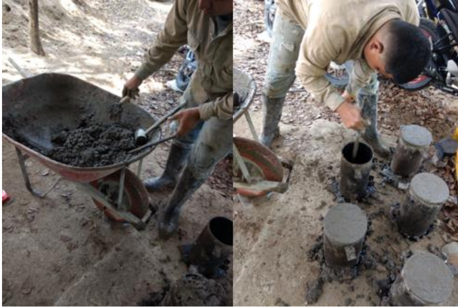
Figura 18. Elaboración de muestras de concreto para ensayos de compresión
