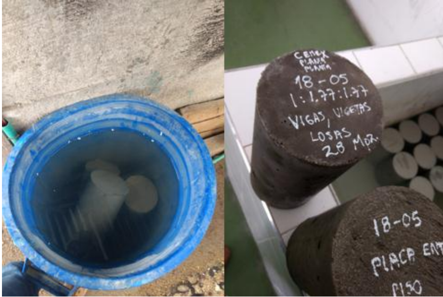
Figura 24. Curado de muestras de concreto
