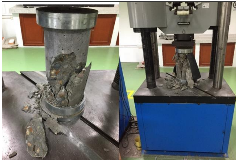
Figura 162. Ensayo de resistencia a la compresión entrepiso 1.
