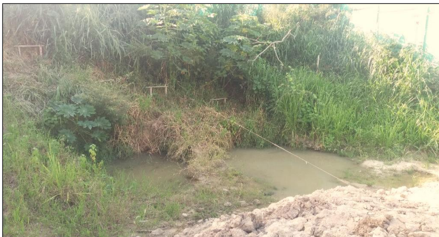
Figura 6. Presencia de nivel freático en el terreno del proyecto.
