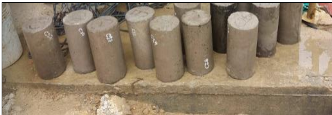
Figura 153. Cilindros para realizarles el ensayo.
