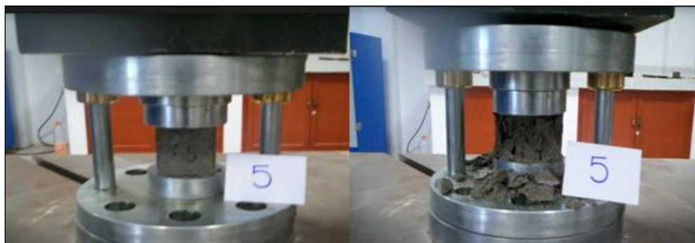
Figura 160. Ensayo a la compresión del mortero.
