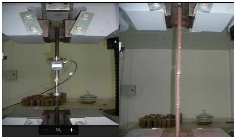
Figura 164. Ensayo de tracción al acero (colocación varilla).
