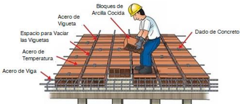
Figura 13. Detalles del proceso de ubicación del bloque de arcilla, 20 .20 . 40 cm.
