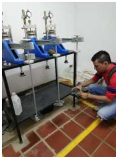
Figura 29. Ensayo de consolidación, aplicación de cargas.
