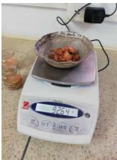
Figura 27. Peso del material saturado.
