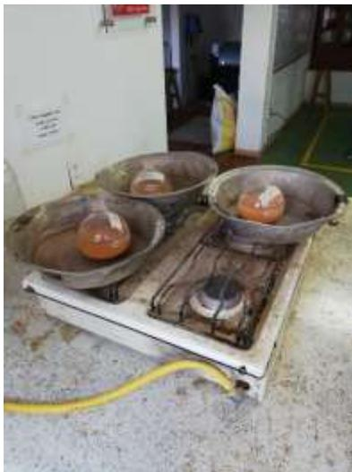
Figura 25. Método de ebullición aplicado para obtener la gravedad específica.
