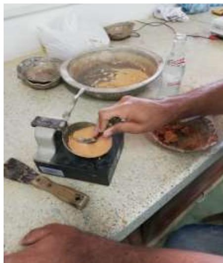
Figura 21. Ensayo de límite líquido.
