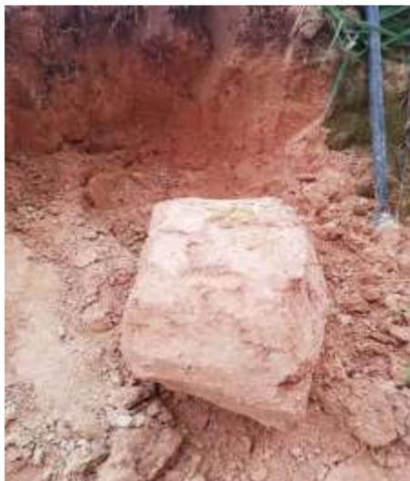
Figura 19. Muestras inalteradas, extracción mediante apiques.
