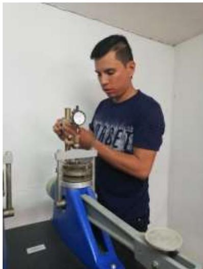
Figura 28. Ensayo de Consolidación, ajuste del deformímetro
