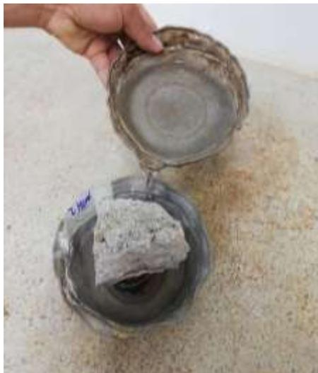
Figura 26. Aplicación del agua destilada en las muestras.
