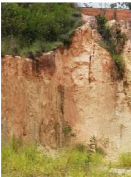
Figura 13. Perfil de Meteorización de El Dorado.
