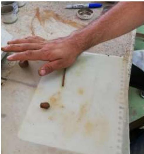
Figura 22. Ensayo de límite plástico.
