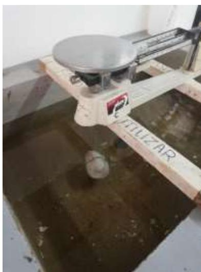
Figura 24. Peso de las muestras sumergidas en agua para obtener su peso unitario.
