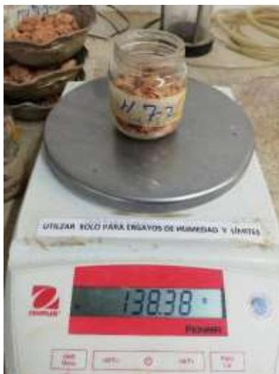
Figura 23. Peso de material inalterado para obtener su contenido de humedad.
