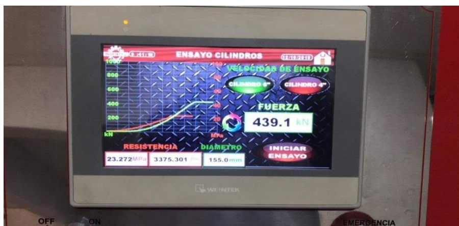
Figura 61. Lectura electrónica de ensayos a los 7 días.
