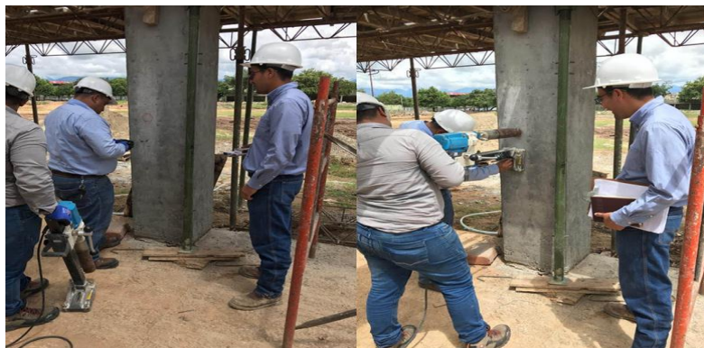
Figura 65. Localización de área y extracción de núcleos.
