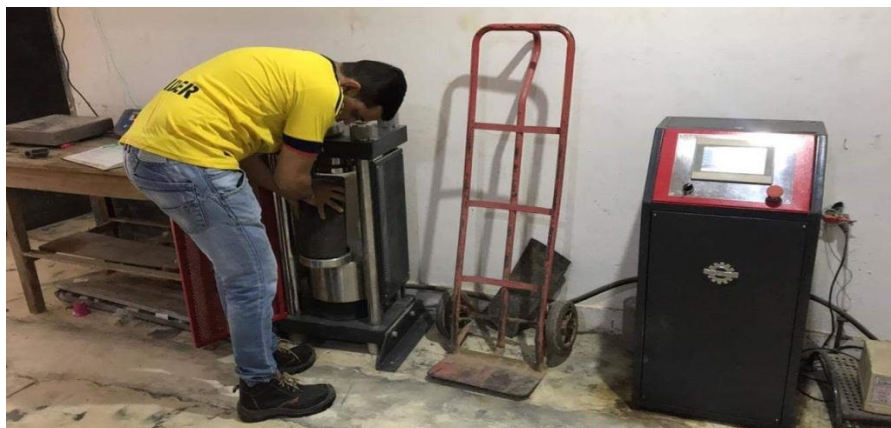
Figura 60. Introducción de espécimen a la máquina de compresión.
