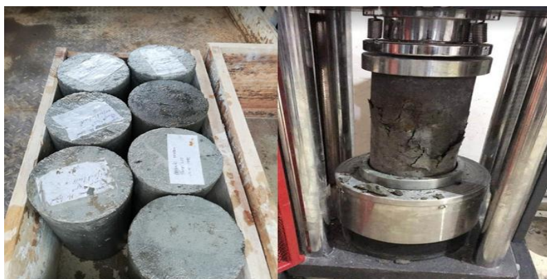
Figura 59. Transporte de muestra y ensayo de compresión en laboratorio.
