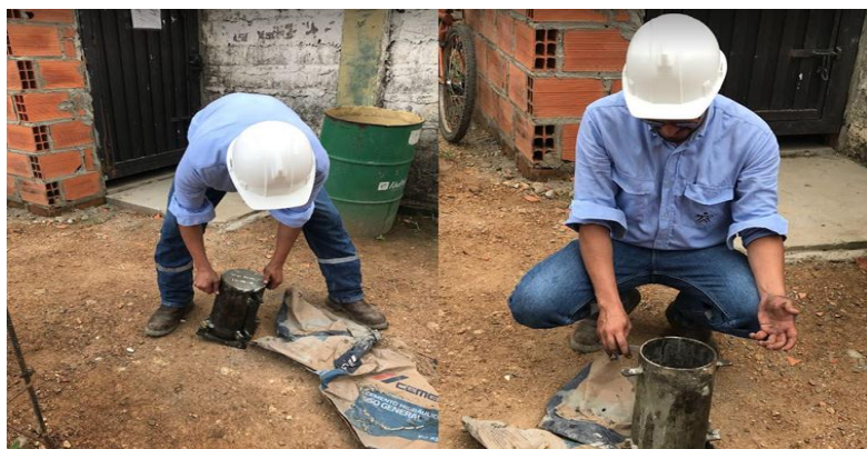
Figura 66. Desencofrado y armado de cilindros para nuevas probetas.
