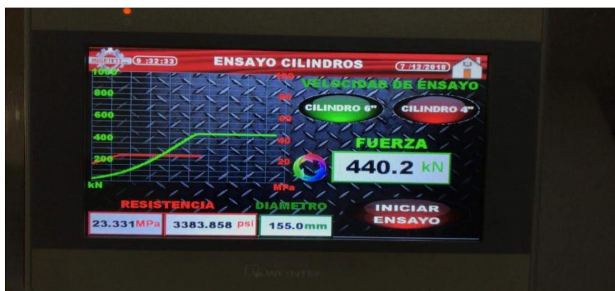
Figura 62. 2 Lectura electrónica de ensayos a los 7 días.
