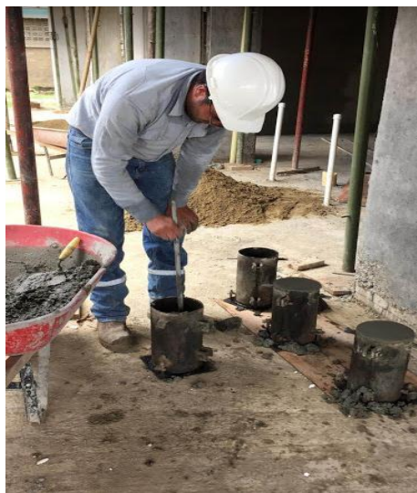
Figura 57. Elaboración de cilindros en concreto.
