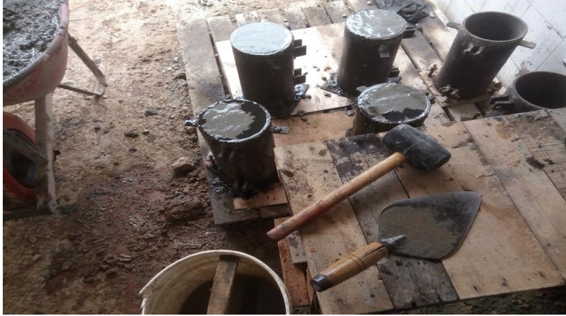
Figura 55. Toma de muestras de cilindros.
