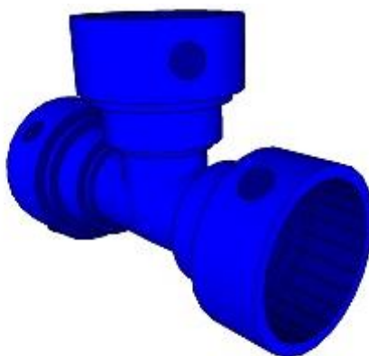
Figura 10. Tee Junta Rápida. Norma de Construcción de Instalación e Intercalado de Hidrantes. (2009). Obtenido: https://www.epm.com.co/site/Portals/2/Documentos/Aguas/NC_AS_IL01_18_Instalacion_e_intercalado_de_hidrantes.pdf?ver=2018-02-23-170125-953
