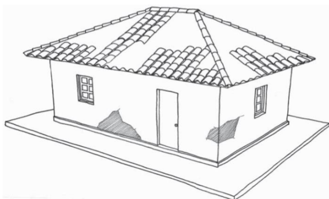
Figura 23. Desprendimiento de material incompatible del muro.
