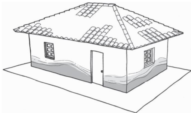
Figura 18. Humedad en el muro. Fuente: (Corporacion de Desarrollo Tecnologico, 2012)
