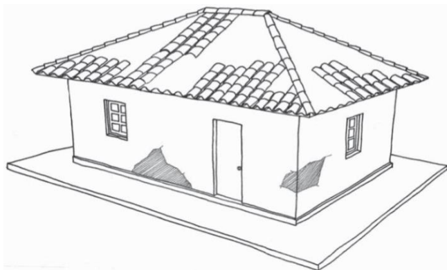
Figura 20. Desprendimiento o erosión del revoque en el muro. Fuente: (Corporacion de Desarrollo Tecnológico, 2012)
