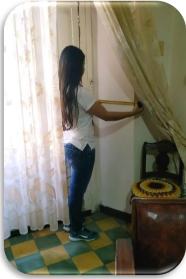
Figura 70. Medición de espesor del muro de tapia pisada Fuente: Autores, 2019
