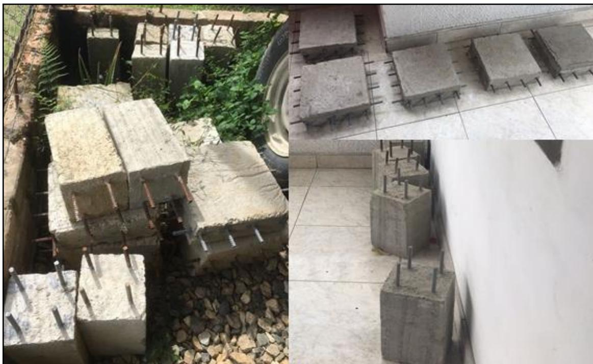
Figura 12. Muestras expuestas al medio ambiente (imagen izquierda) y muestras protegidas bajo sombra (imágenes a la derecha). Fuente: Autores de la investigación.
