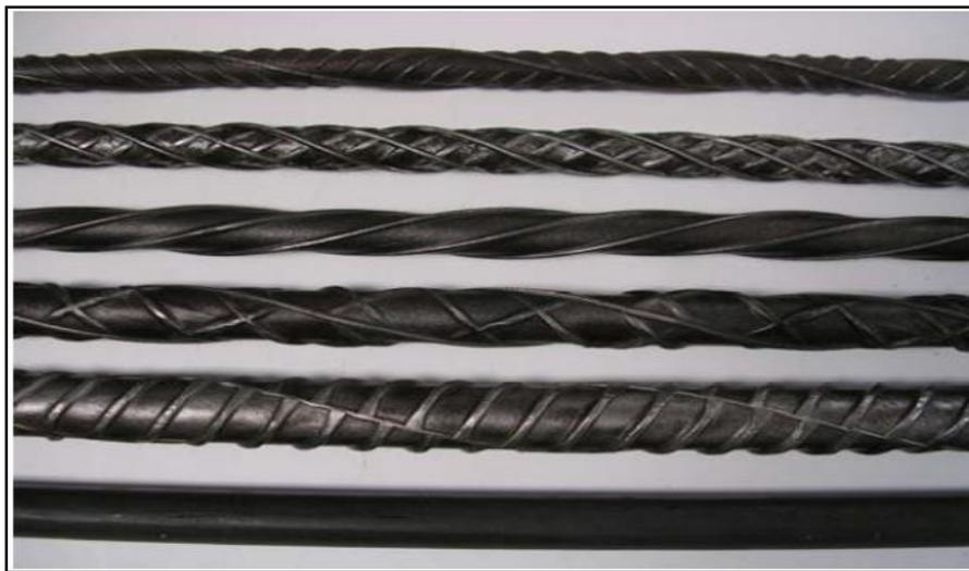
Figura 1. Aceros de refuerzo empleado para hormigón. Fuente: Moreno Fernández E. (2008)
