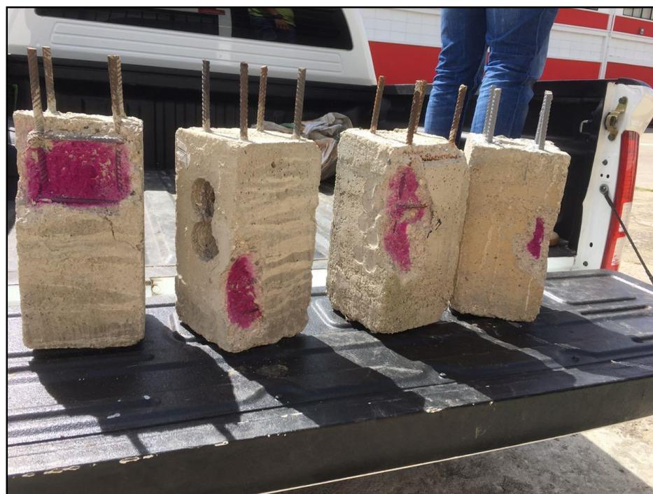
Figura 22. Aplicación de fenolftaleína a concreto desportillado. Fuente: Autores de la investigación
