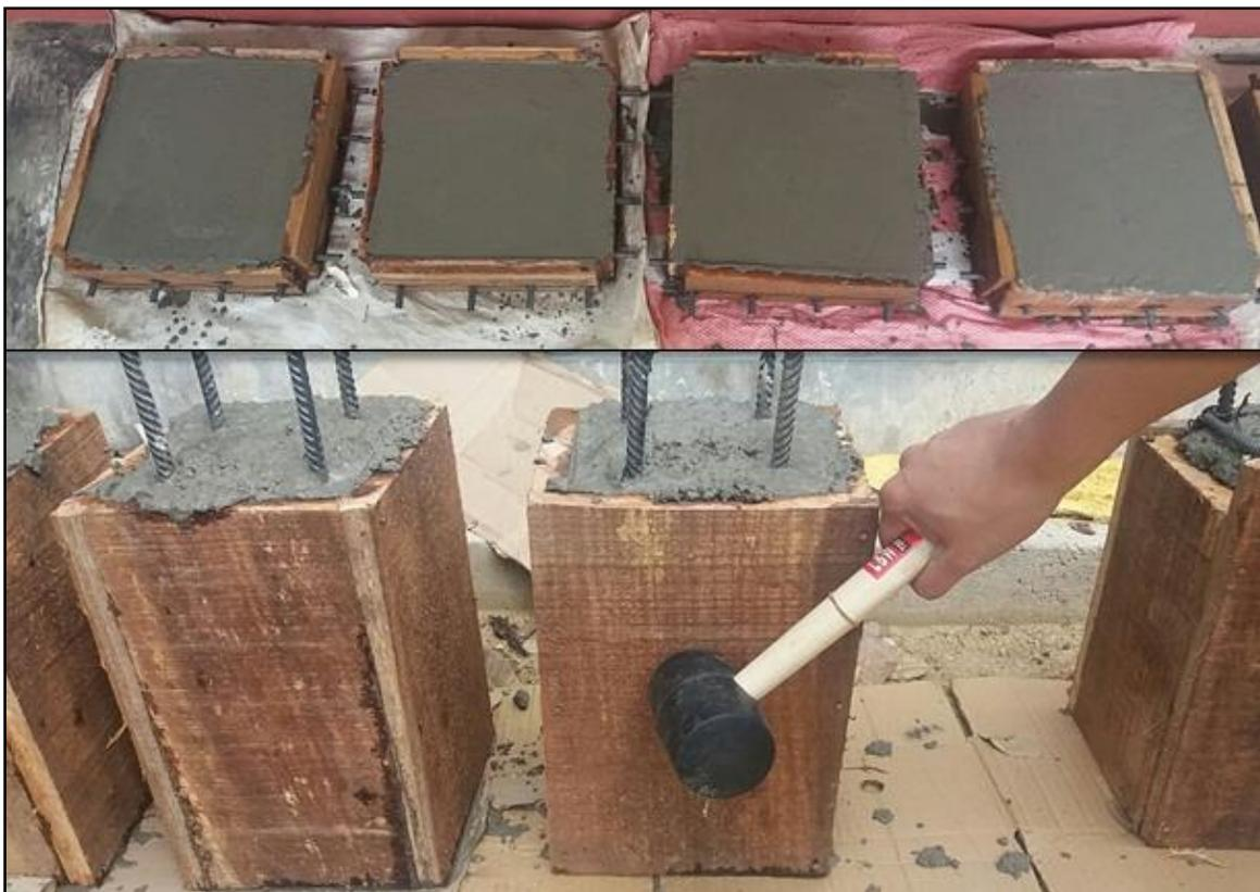
Figura 10. Vibración de concreto con martillo de goma. Fuente: Autores de la investigación.
