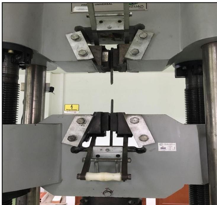
Figura 17. Ensayo a tensión del acero corrugado. Fuente: Autores de la investigación
