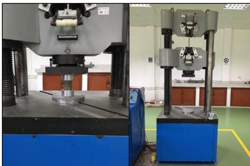
Figura 14. Maquina universal Ensayo compresión. Fuente: Autores de la investigación.
