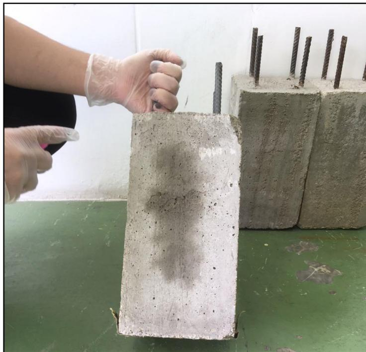
Figura 21. Aplicación de fenolftaleína a probeta. Fuente: Autores de la investigación.
