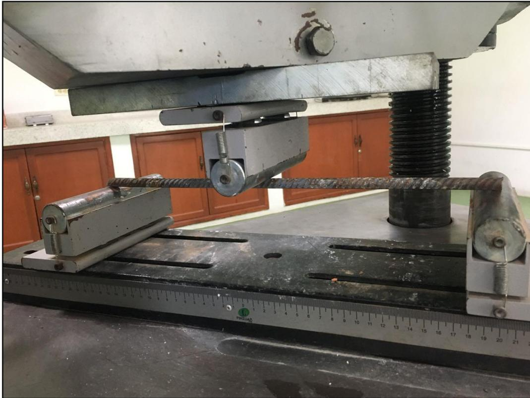
Figura 15. Ensayo a Flexión del acero corrugado. Fuente: Autores de la investigación.
