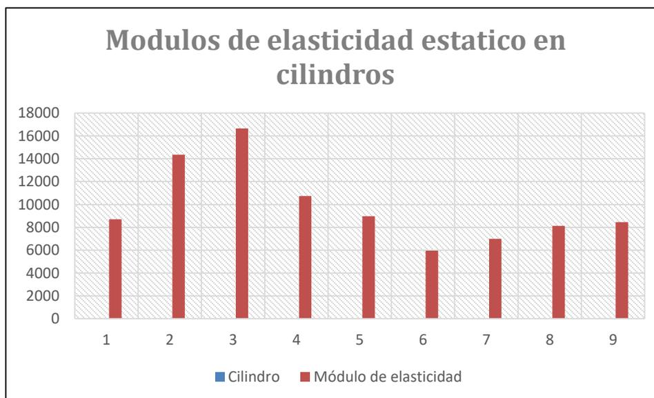
Figura 24. Módulos de elasticidad de cilindros evaluados. Fuente: Autores de la investigación.
