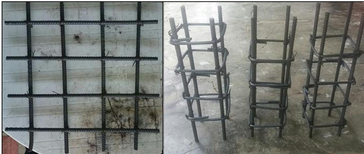
Figura 8. Armado de acero de refuerzo para muestras de ensayo. Fuente: Autores de la investigación.
