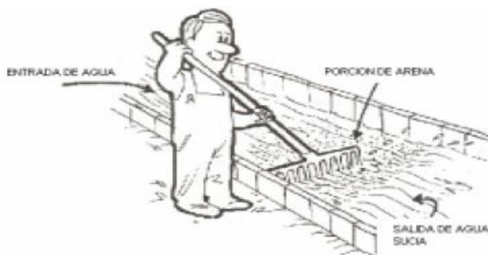
Figura 19. Lavado de arena manual. (2015). CINARA.
