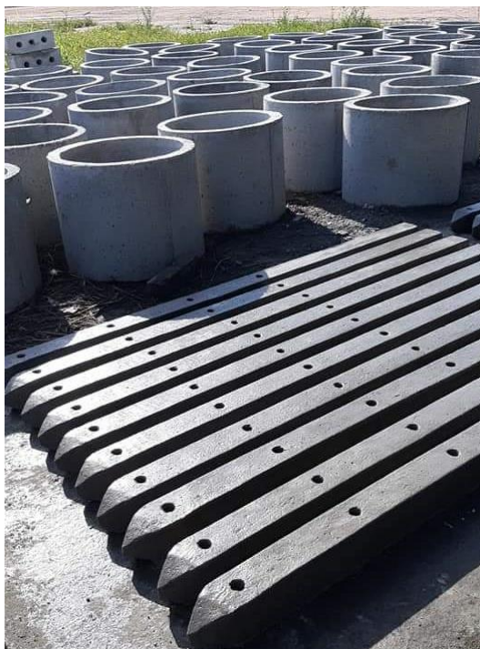
Figura 51. Postes para cercamiento y tubos de alcantarillado
