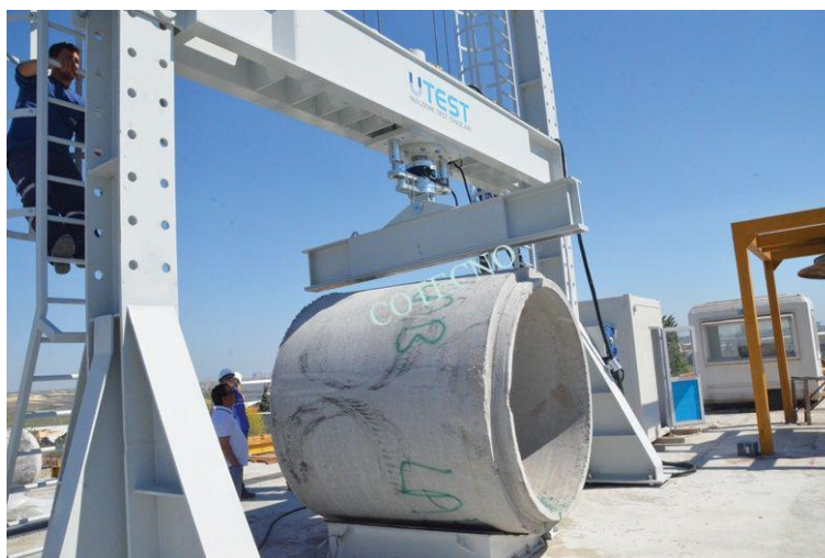
Figura 63. Obtención de resistencia en secciones de concreto para pozos de acuerdo a la NTC 3676: Métodos de ensayo para tubos y secciones de pozos de inspección prefabricados en concretos
