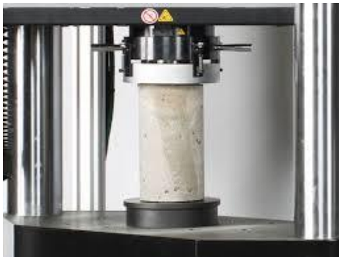
Figura 54. Obtención de la carga axial de compresión en cilindros de concreto de acuerdo a la NTC 673: Concretos, ensayo de resistencia a la compresión de especímenes cilíndricos de concreto
