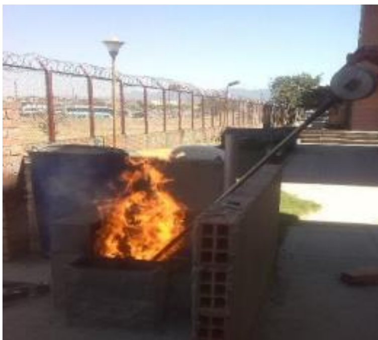
Figura 59. Bloques de concreto expuestos al fuego en base a lo indicado en la NTC 1480: Elementos de construcción ensayo de resistencia al fuego
