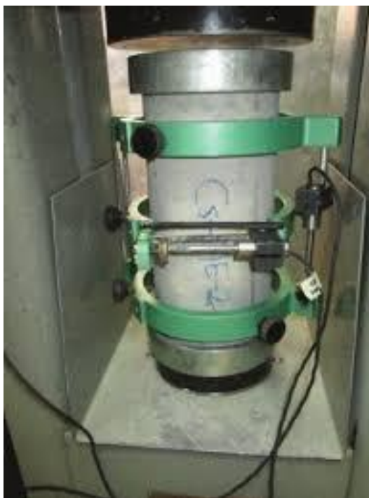
Figura 58. Obtención del módulo de elasticidad y la relación de Poisson mediante un Compresómetro - Expansómetro para cilindros de concreto basados en la NTC 4025: Concretos. Método de ensayo para determinar el módulo de elasticidad estático
