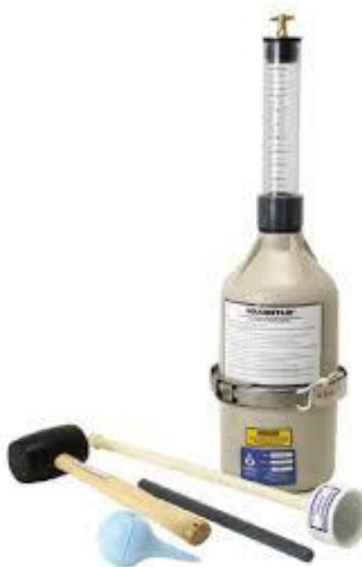
Figura 57. Medidor de aire para concreto fresco por el método volumétrico requerido para aplicar la NTC 1028: Ingeniería civil y arquitectura, determinación del contenido de aire en concreto fresco método volumétrico
