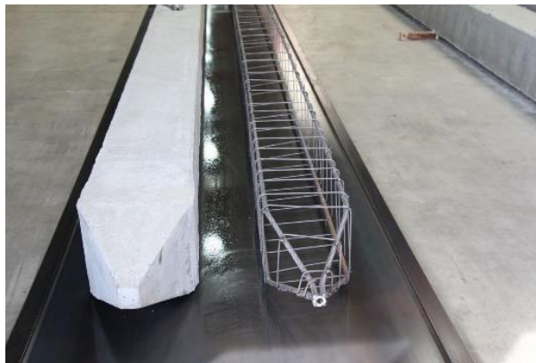
Figura 16. Pilote y su armado de acero.
