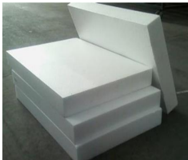
Figura 5. Bloques de poliestireno expandido. Fuente: Geofoam Formapol, (2018)
