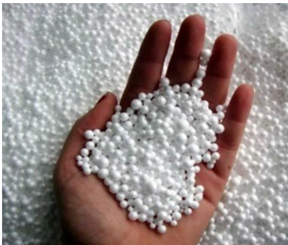
Figura 4. Perlas de poliestireno expandido. Fuente: https://aislatermic.com.co
