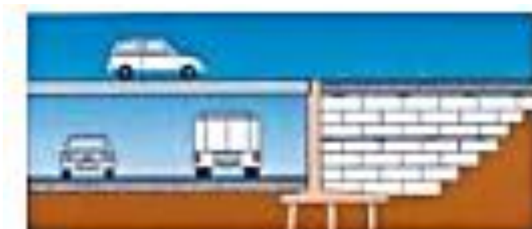
Figura 13. Fuerzas horizontales sobre la estructura.
