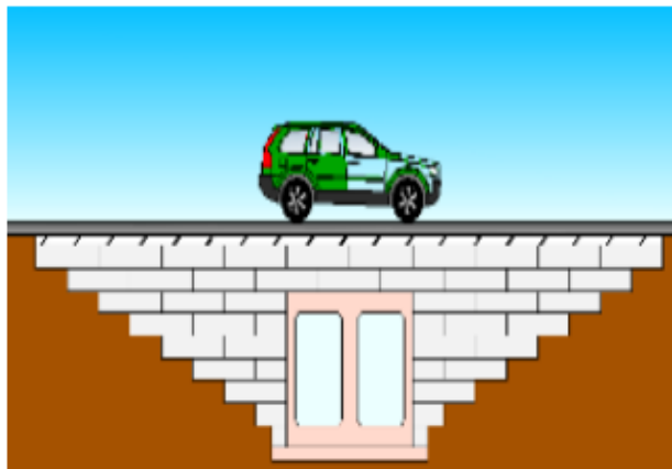
Figura 9. Ductos y estructuras adyacentes o embebidas.
