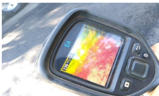
Figura 68. Toma de temperatura de la mezcla asfáltica compactada. Fuente: autor, 2019.
