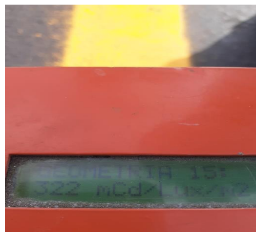
Figura 25. Registro de reflectividad de línea amarilla de demarcación vial., Autor, 2019.
