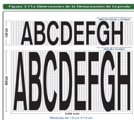
Figura 14. Dimensiones de la demarcación de leyenda de las señales verticales, (2015). Obtenido de: manual de señalización vial
