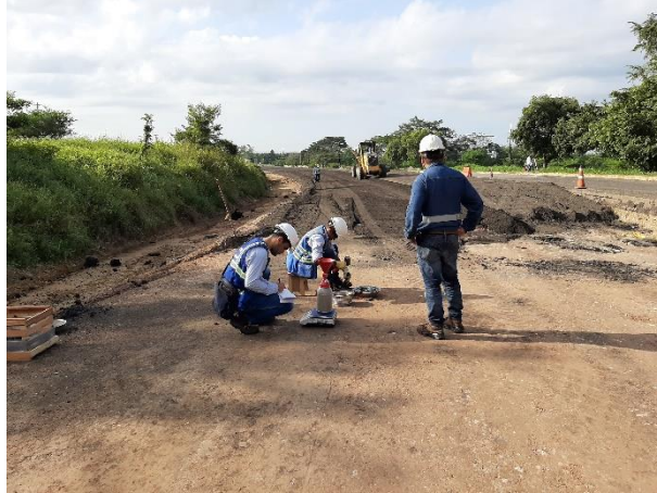
Figura 60. Toma de densidades con cono y arena pr 90, autor, 2019.
