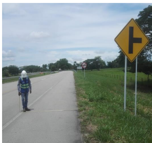
Figura 6. Medición de longitud de la señal vertical. Autor, 2019.
