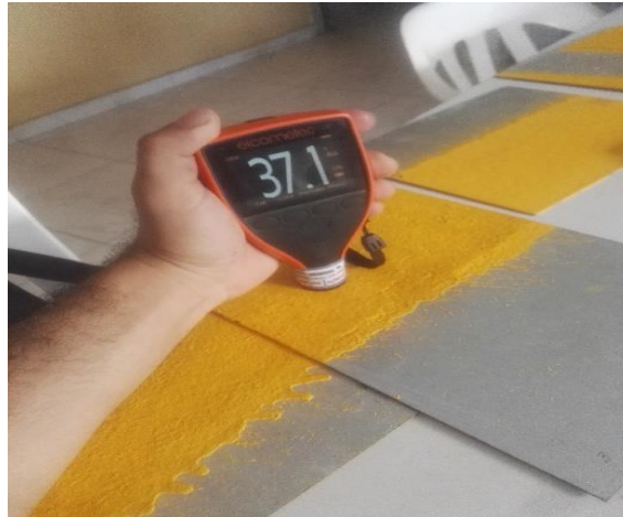
Figura 23. Toma de espesor de demarcación vial, autor, 2019.
