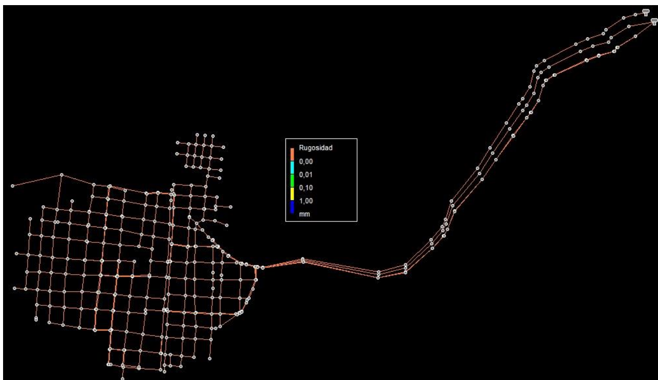
Figura 20. Rugosidad del PVC en Epanet. Fuente: Autores 2020.
