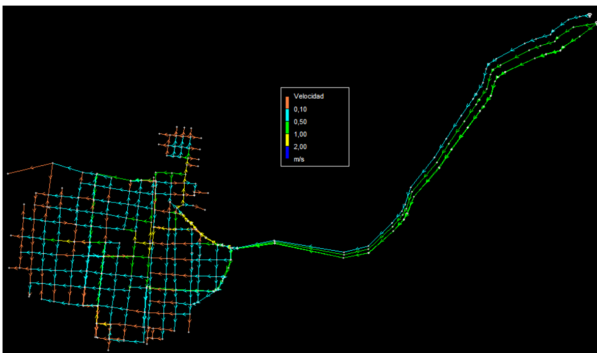
Figura 19. Diferencia de velocidades en Epanet. Fuente: Autores 2020.
