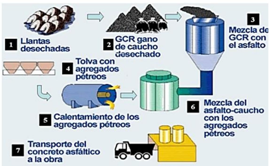
Figura 11. Procedimiento para fabricar el asfalto-caucho por Vía Húmeda. Fuente: Ramírez, Ladino & Rosas, (2014), p.17.
