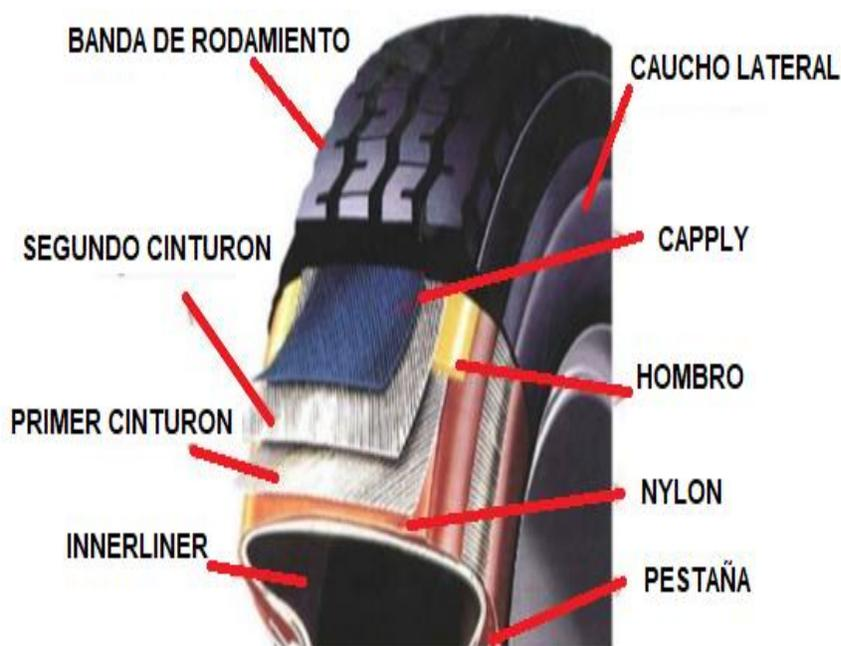
Figura 10. Composición de una llanta. Fuente: (Albañil & Ortega, 2019).
