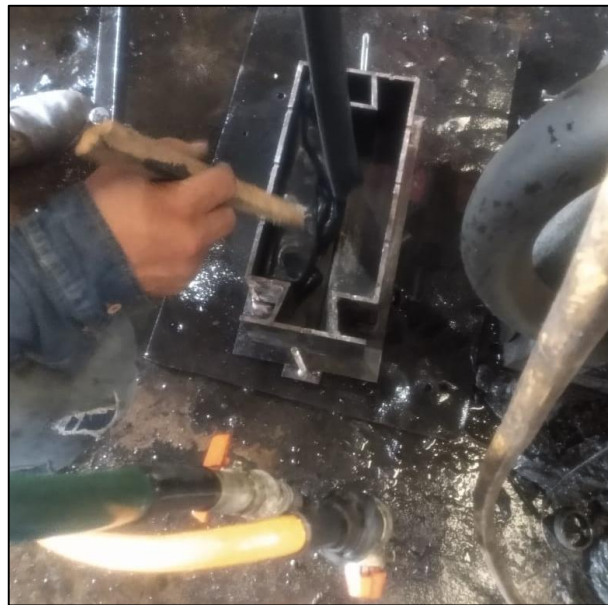
Figura 24. Fundición del material en molde. Autores, (2020).
