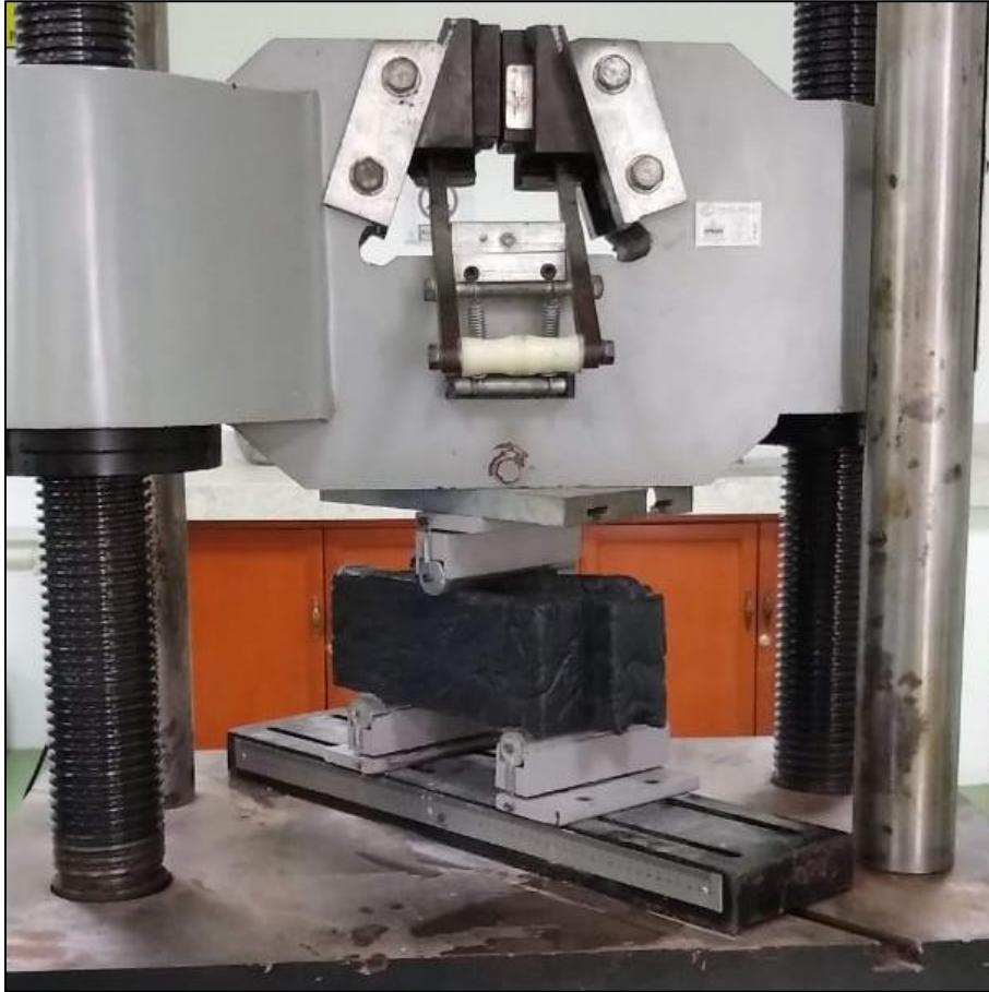
Figura 45. Placa y barras de acero adaptado en la máquina universal. Autores del proyecto, 2020.
