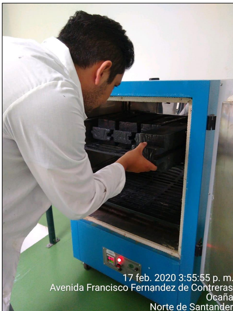
Figura 42. Secado de prototipos a temperatura controlada. Autores, (2020)
