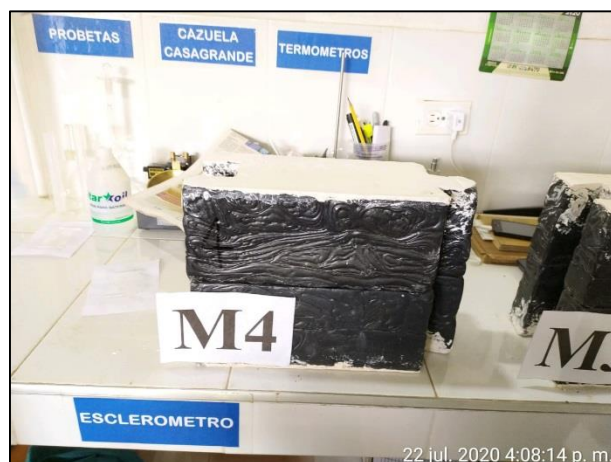
Figura 51. Muestras de prismas de PEAD. Autores, (2020)
