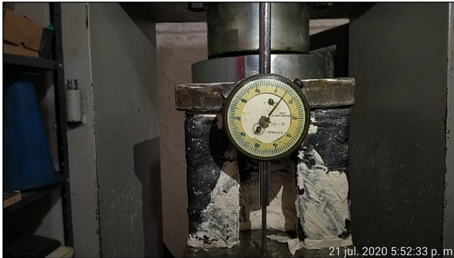
Figura 39. Ensayo de compresión en prototipo del ladrillo. Autores del proyecto, 2020.
