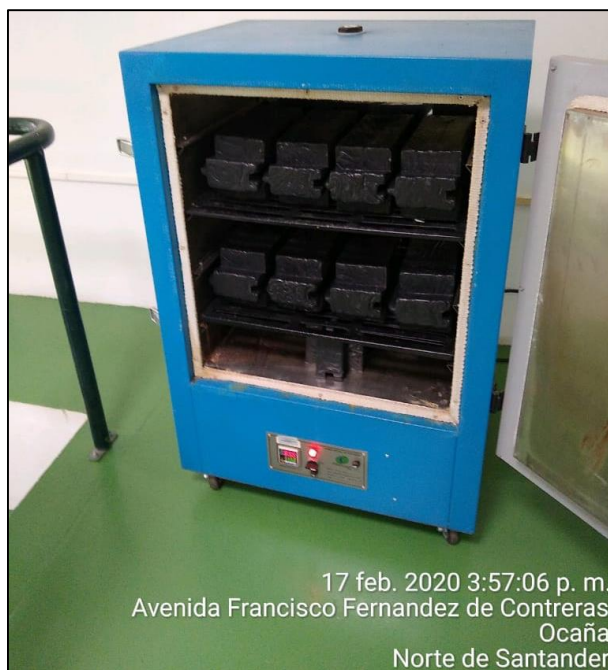
Figura 31. Secado de unidades de mampostería de PEAD. Autores del proyecto, 2020.
