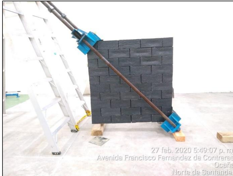
Figura 76. Instalación del equipo para el ensayo de tracción diagonal. Autores del proyecto, 2020.
