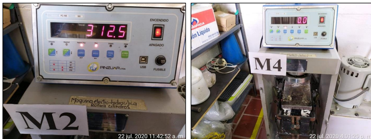
Figura 55. Aplicación de carga y cronometraje en ensayo de prismas de ladrillos de PEAD. Autores, (2020)
