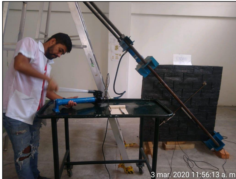
Figura 79. Aplicación de la carga al murete. Autores del proyecto, 2020.
