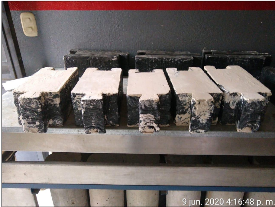
Figura 36. Cara de ladrillo completamente refrentada. Autores, (2020).
