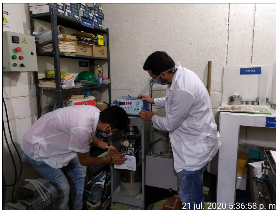
Figura 37. Montaje del espécimen a ensayar. Autores del proyecto, 2020.
