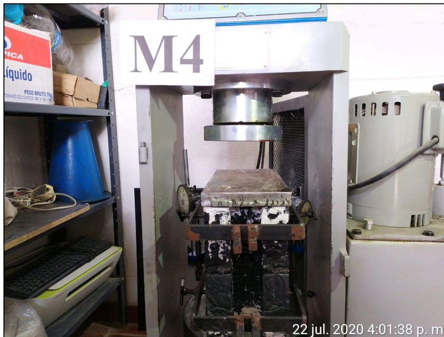
Figura 54. Equipo de ensayo de los prismas de PEAD. Autores, (2020)
