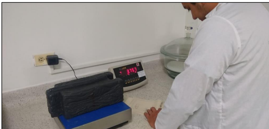
Figura 33. Pesaje del ladrillo luego del secado. Autores del proyecto, 2020.
