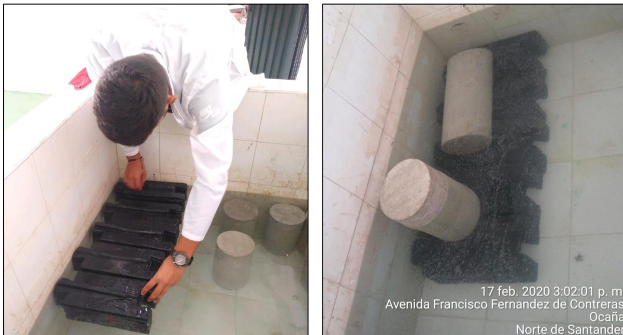
Figura 43. Inmersión de los prototipos en prueba de absorción. Autores, (2020)
