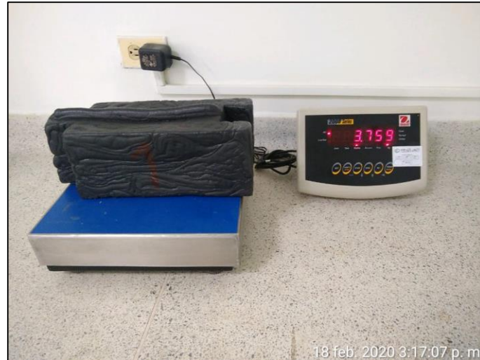
Figura 29. Primer pesaje de ladrillos. Autores del proyecto, 2020.
