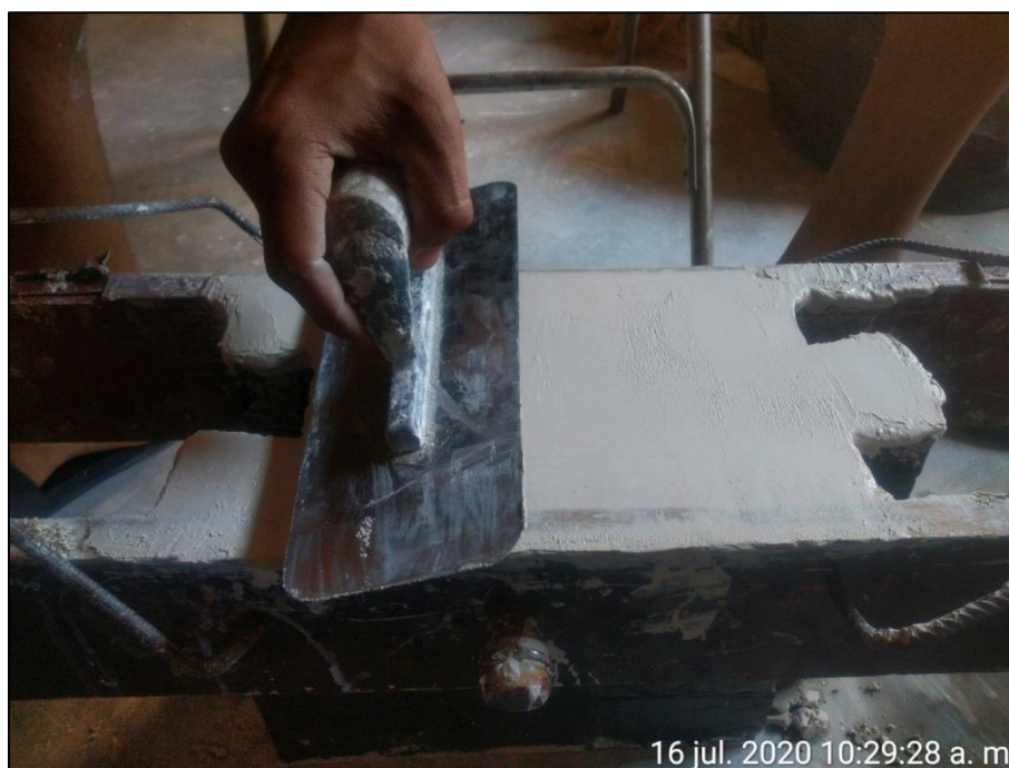
Figura 50. Refrentado de caras de área de contacto de carga del prisma. Autores, (2020)
