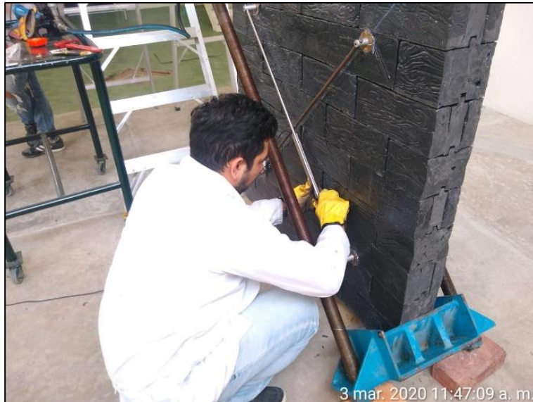
Figura 78. Colocación de los LVDT en los muretes. Autores del proyecto, 2020.
