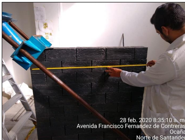
Figura 77. Medición de las dimensiones del murete. Autores del proyecto, 2020.
