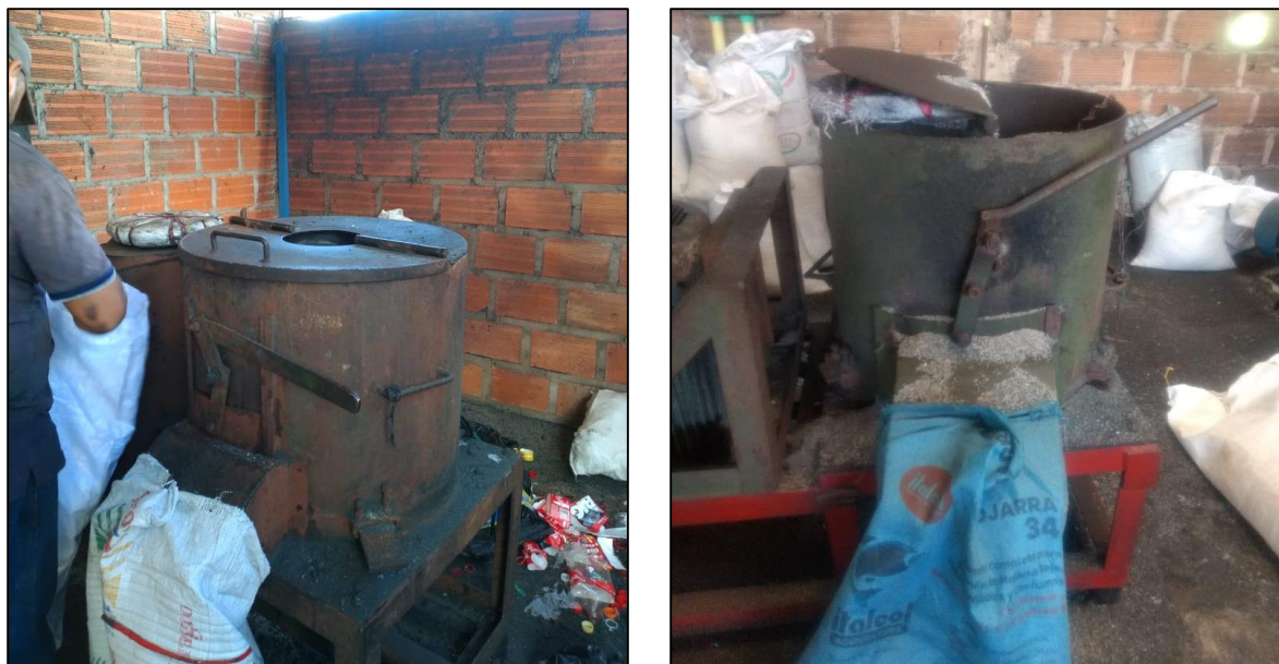
Figura 20. Maquina Aglutinadora. Autores, (2020).
