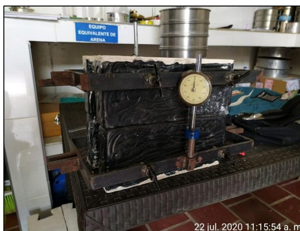
Figura 53. Instalación de deformímetro análogo. Autores, (2020)
