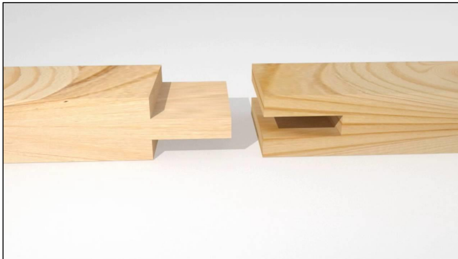
Figura 5. Ensamble tipo horquilla. López, R. (2020). Ensamble de horquilla. [Video] obtenido de: https://www.youtube.com/watch?v=nA3BEdWybdA
