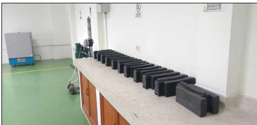
Figura 34. Enfriamiento de especímenes. Autores del proyecto, 2020.
