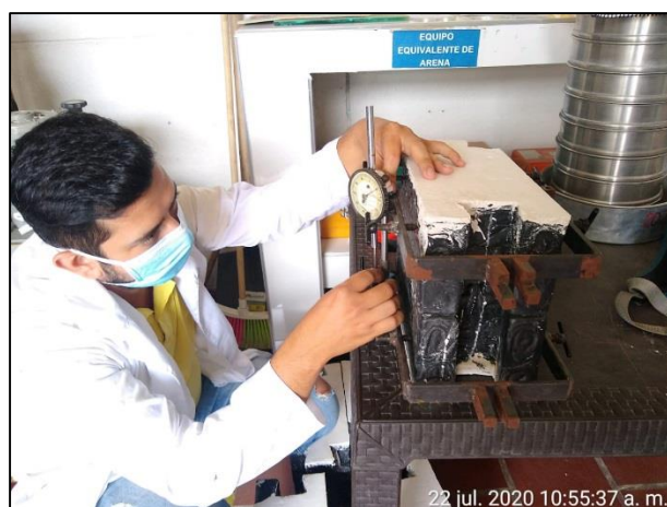
Figura 53. Instalación de deformímetro análogo. Autores, (2020)
