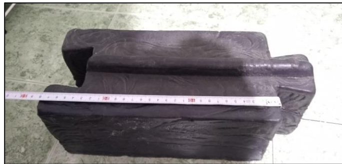
Figura 30. Medición de unidades (altura, largo, ancho)
