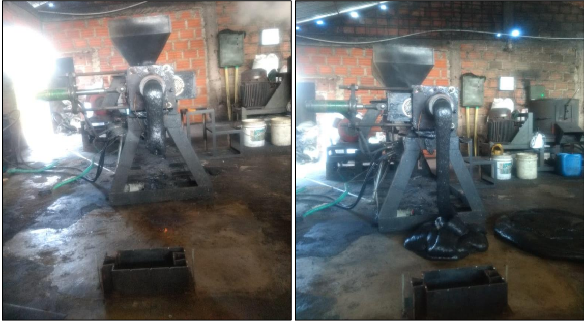
Figura 23. Filtrado final del material. Autores, (2020).
