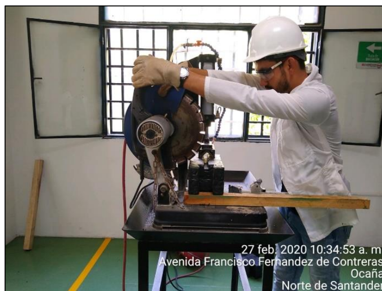
Figura 72. Corte de ladrillos de PEAD con la sierra. Autores del proyecto, 2020.
