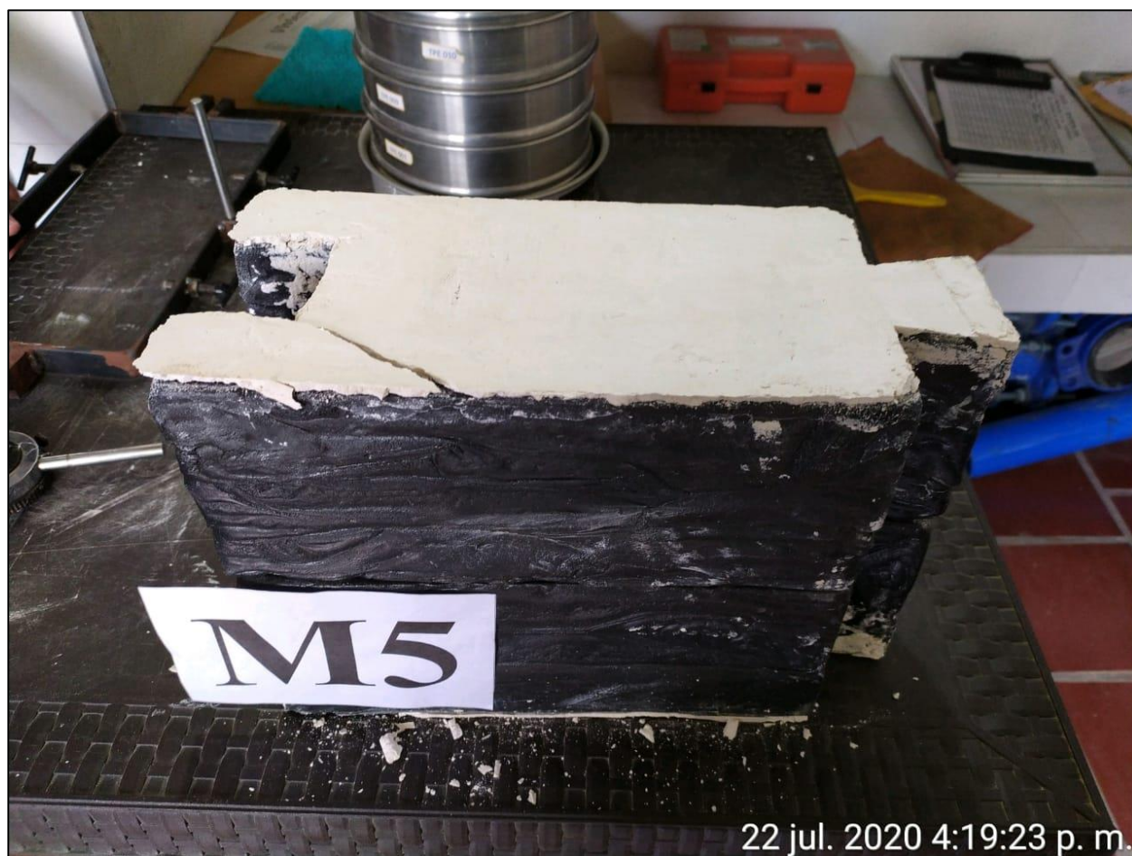
Figura 56. Falla por aplastamiento en Prisma de PEAD. Autores, (2020)
