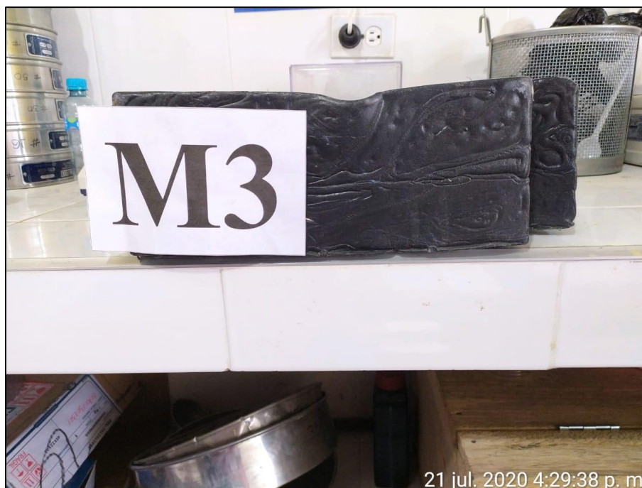
Figura 47. Falla del Prototipo luego de aplicación de carga. Autores, (2020)
