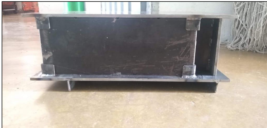
Figura 18. Molde de acero del prototipo (vista lateral). Autores, (2020).
