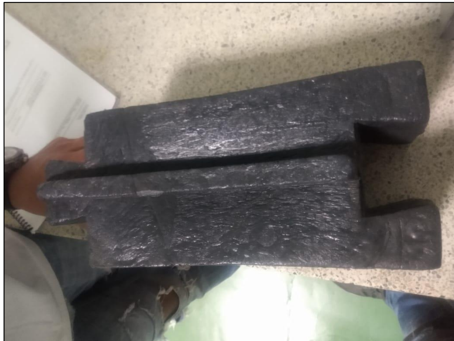
Figura 27. Prototipo de ladrillo de PEAD fundido y desencofrado terminado. Autores, (2020).
