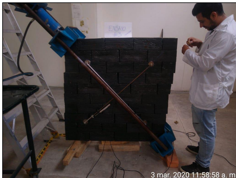
Figura 80. Deslizamiento del muro por tracción diagonal. Autores del proyecto, 2020.
