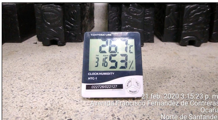
Figura 44. Control de temperatura en cuarto de secado. Autores, (2020)
