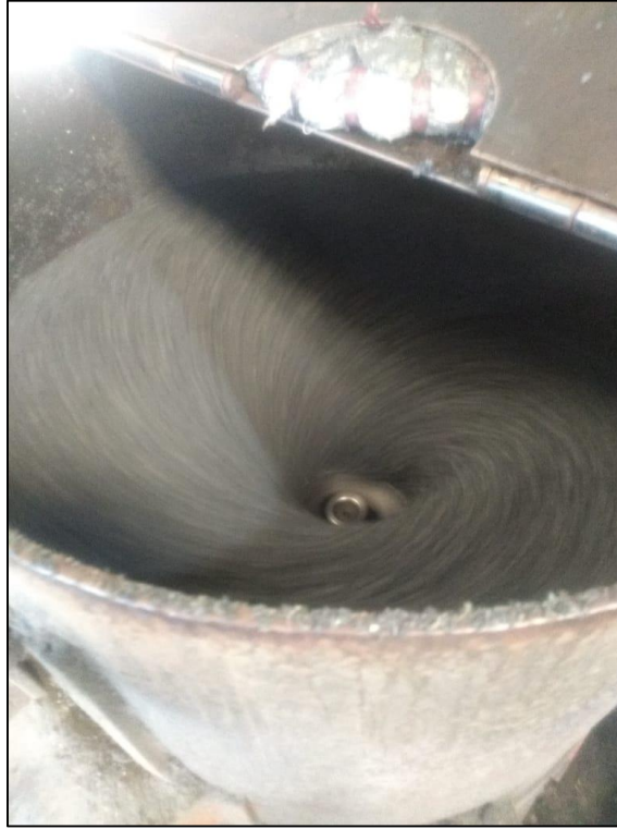
Figura 22. Segundo aglutinamiento del PEAD. Autores, (2020).
