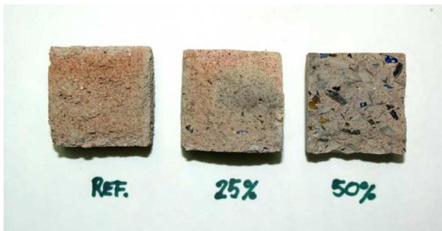
*Figura 64.* Alteración cromática en las probetas tras el proceso de calentamiento a 800°C.
