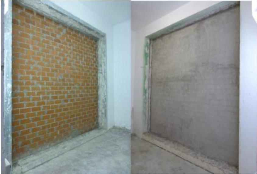
*Figura 80.* Pared base en emisión (izquierda) y en recepción (derecha).
