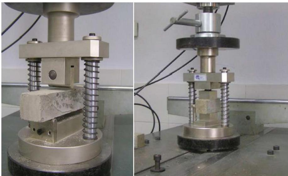
*Figura 60.* Dispositivo de ensayo a flexión y compresión.
