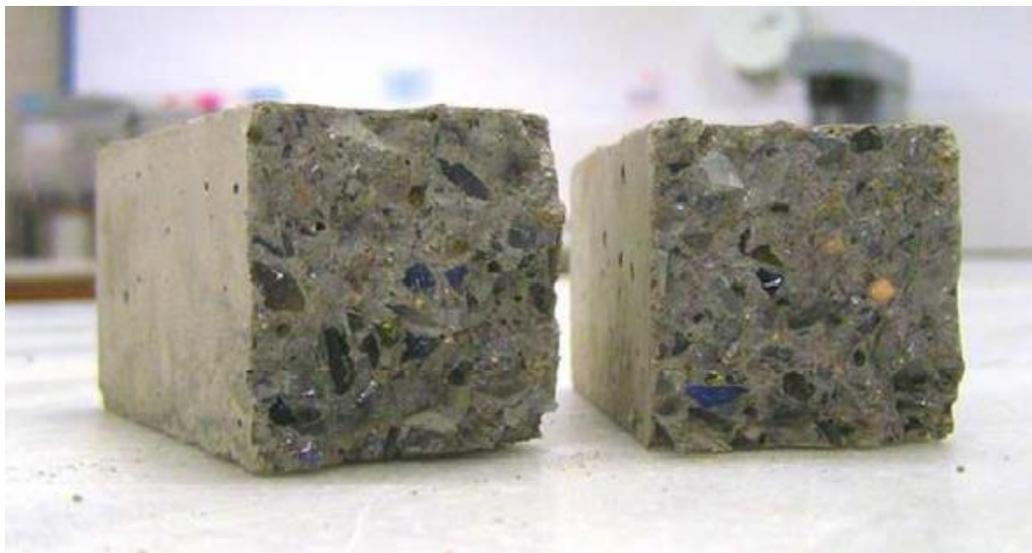
*Figura 61.* Imagen de la distribución del agregado de vidrio triturado en el interior de las probetas de mortero (m50).
