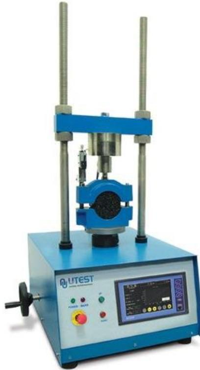
*Figura 22.* Equipo empleado para realización del ensayo de estabilidad y flujo. Obtenido en: <http://proetisa.com/proetisa-productos.php?ID=219>
