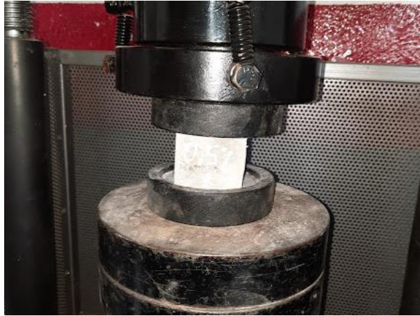
Figura 49. Ensayo resistencia a la compresión a los 28 días en cubos de mortero con 0,5% de fibras. Autores, 2021.
