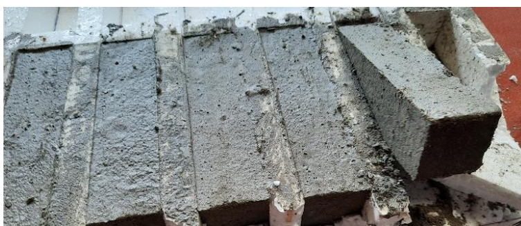
Figura 18. Retiro de las probetas de mortero del molde de icopor. Autores, 2021.
