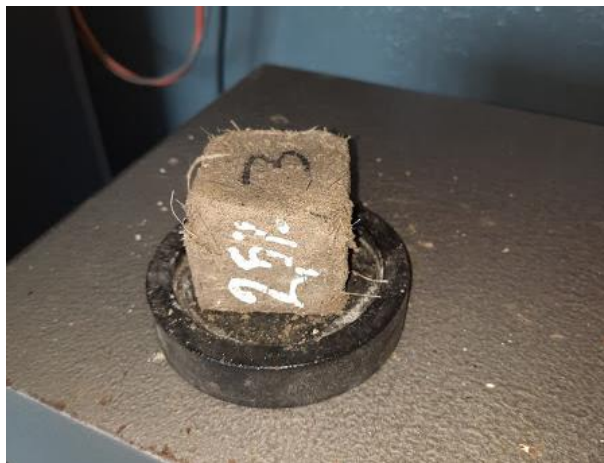
Figura 46. Ensayo resistencia a la compresión a los 7 días en cubos de mortero con 2,5% de fibras. Autores, 2021.
