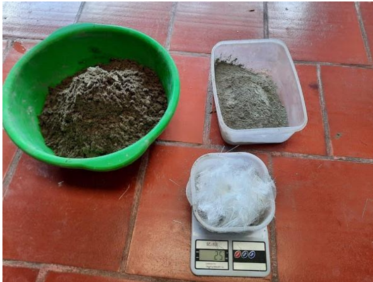
Figura 33. Pesaje de las fibras para mezclas de mortero. Autores, 2021.
