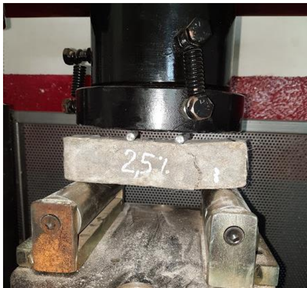
Figura 72. Ensayo resistencia a la flexión a los 28 días en vigas de mortero con 2,5% de fibras. Autores, 2021.
