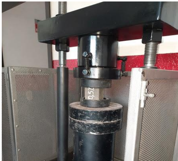
Figura 41. Ensayo resistencia a la compresión a los 7 días en cubos de mortero con 0,5% de fibras. Autores, 2021.
