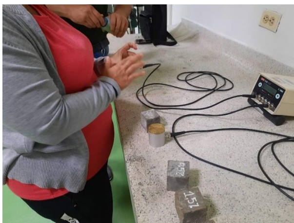
Figura 76. Calibración de equipos del ensayo ultrasonido. Autores, 2021.
