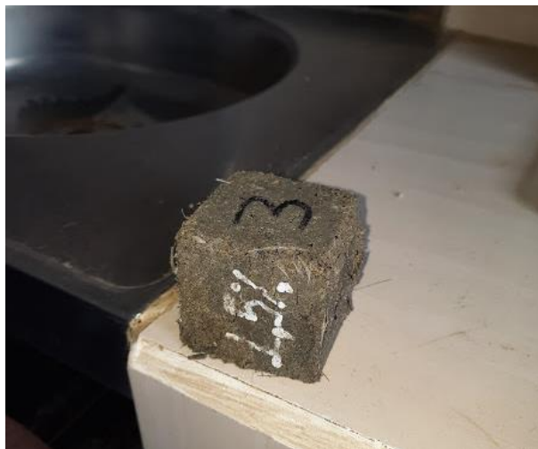
Figura 44. Ensayo resistencia a la compresión a los 7 días en cubos de mortero con 1,5% de fibras. Autores, 2021.
