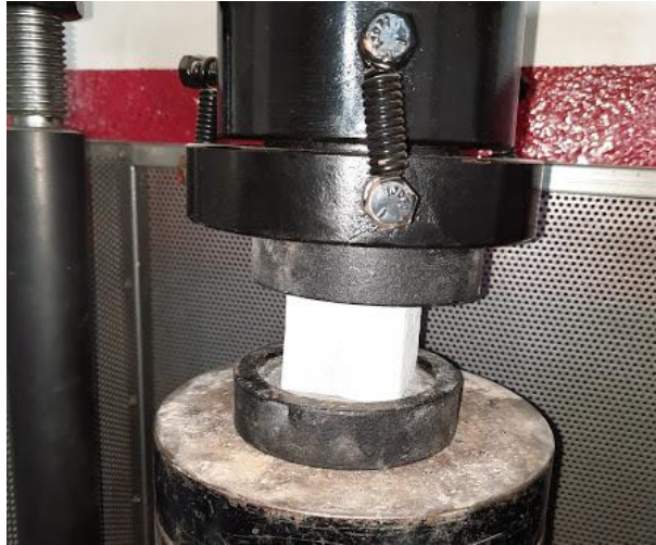
Figura 47. Ensayo resistencia a la compresión a los 28 días en cubos de mortero con 0% de fibras. Autores, 2021.
