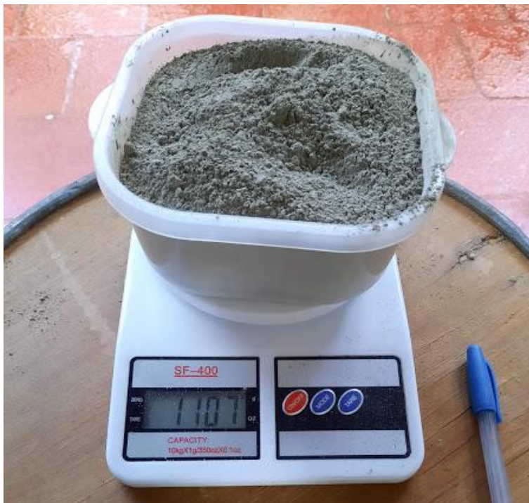
Figura 32. Pesaje del cemento para mezclas de mortero. Autores, 2021.
