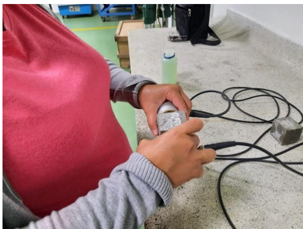
Figura 78. Ensayo por ultrasonido cubo con 0,5% de fibras. Autores, 2021.
