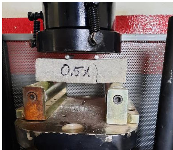
Figura 60. Ensayo resistencia a la flexión a los 14 días en vigas de mortero con 0,5% de fibras. Autores, 2021.
