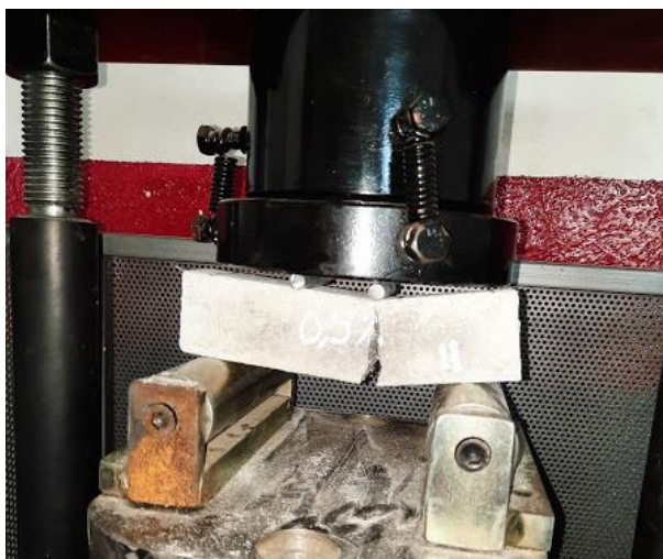
Figura 68. Ensayo resistencia a la flexión a los 28 días en vigas de mortero con 0,5% de fibras. Autores, 2021.
