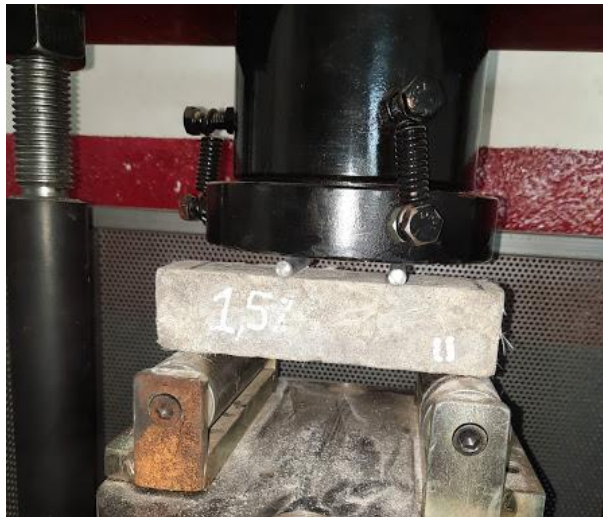
Figura 69. Ensayo resistencia a la flexión a los 28 días en vigas de mortero con 1,5% de fibras. Autores, 2021.
