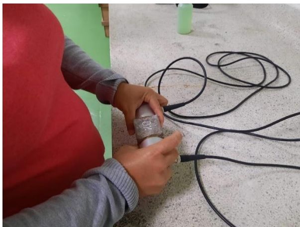
Figura 77. Ensayo por ultrasonido cubo con 0% de fibras. Autores, 2021.
