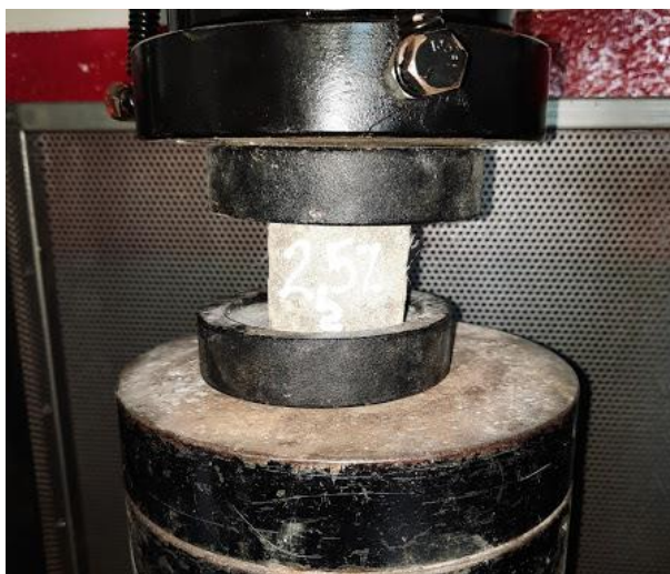
Figura 53. Ensayo resistencia a la compresión a los 28 días en cubos de mortero con 2,5% de fibras. Autores, 2021.
