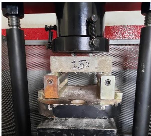
Figura 61. Ensayo resistencia a la flexión a los 14 días en vigas de mortero con 1,5% de fibras. Autores, 2021.
