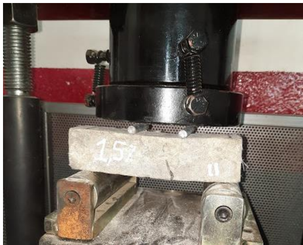
Figura 70. Ensayo resistencia a la flexión a los 28 días en vigas de mortero con 1,5% de fibras. Autores, 2021.
