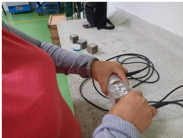
Figura 80. Ensayo por ultrasonido cubo con 2,5% de fibras. Autores, 2021.
