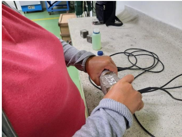
Figura 79. Ensayo por ultrasonido cubo con 1,5% de fibras. Autores, 2021.
