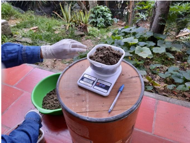
Figura 31. Pesaje de arena para mezclas de mortero. Autores, 2021.
