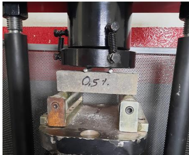
Figura 59. Ensayo resistencia a la flexión a los 14 días en vigas de mortero con 0,5% de fibras. Autores, 2021.
