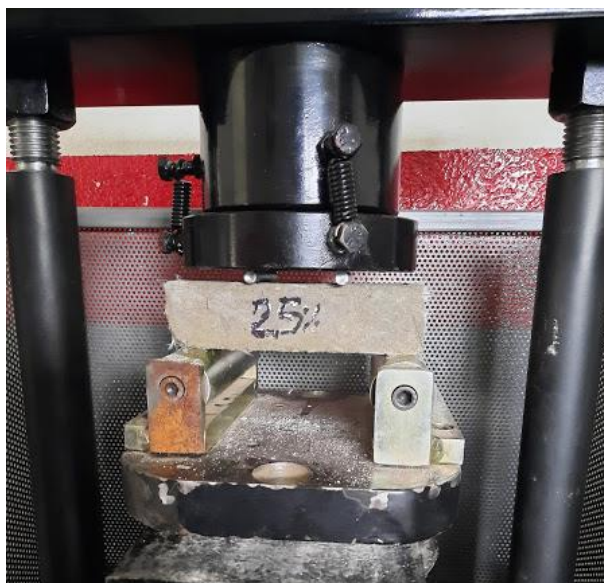
Figura 63. Ensayo resistencia a la flexión a los 14 días en vigas de mortero con 2,5% de fibras. Autores, 2021.
