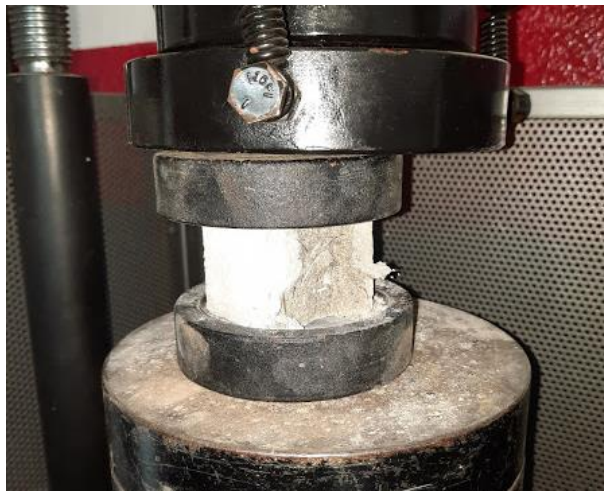
Figura 50. Ensayo resistencia a la compresión a los 28 días en cubos de mortero con 0,5% de fibras. Autores, 2021.
