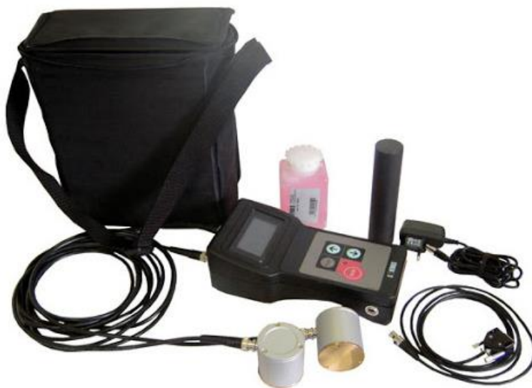
Figura 4. Equipo para ensayo de Ultrasonido. Obtenido en: http://www.adatec.co.cr/route.php?url=equipovelocidadimpulsosultrasonicos
