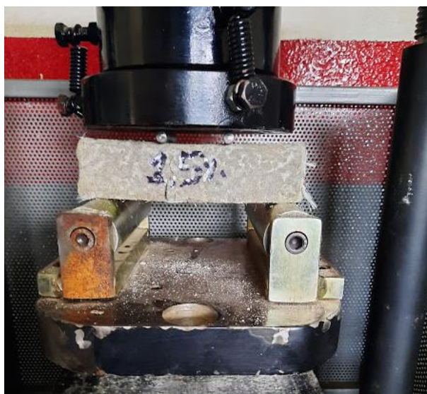
Figura 62. Ensayo resistencia a la flexión a los 14 días en vigas de mortero con 1,5% de fibras. Autores, 2021.
