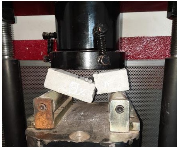
Figura 65. Ensayo resistencia a la flexión a los 28 días en vigas de mortero con 0% de fibras. Autores, 2021.
