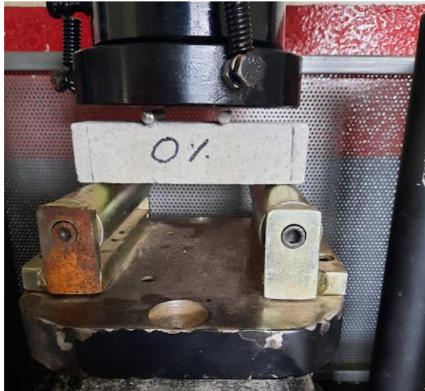
Figura 57. Ensayo resistencia a la flexión a los 14 días en vigas de mortero con 0% de fibras. Autores, 2021.
