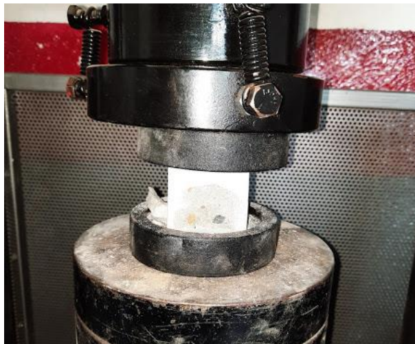
Figura 48. Ensayo resistencia a la compresión a los 28 días en cubos de mortero con 0% de fibras. Autores, 2021.
