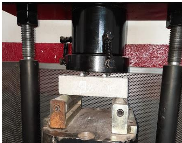
Figura 66. Ensayo resistencia a la flexión a los 28 días en vigas de mortero con 0% de fibras. Autores, 2021.
