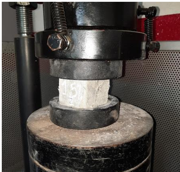
Figura 52. Ensayo resistencia a la compresión a los 28 días en cubos de mortero con 1,5% de fibras. Autores, 2021.
