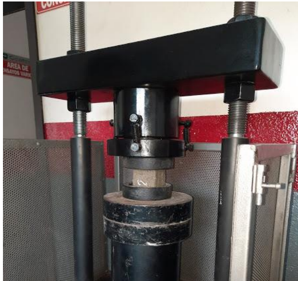
Figura 43. Ensayo resistencia a la compresión a los 7 días en cubos de mortero con 1,5% de fibras. Autores, 2021.
