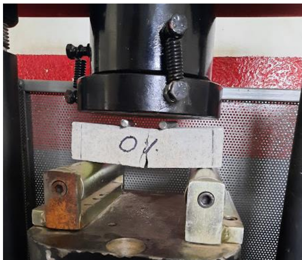
Figura 58. Ensayo resistencia a la flexión a los 14 días en vigas de mortero con 0% de fibras. Autores, 2021.
