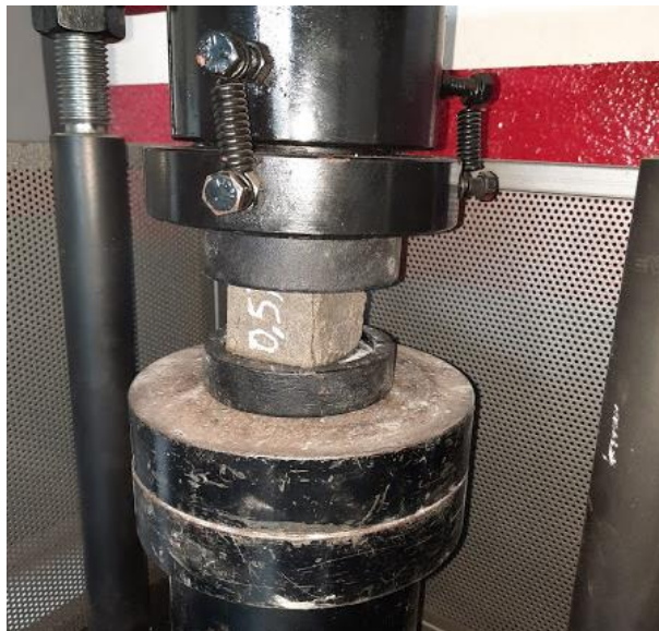
Figura 42. Ensayo resistencia a la compresión a los 7 días en cubos de mortero con 0,5% de fibras. Autores, 2021.
