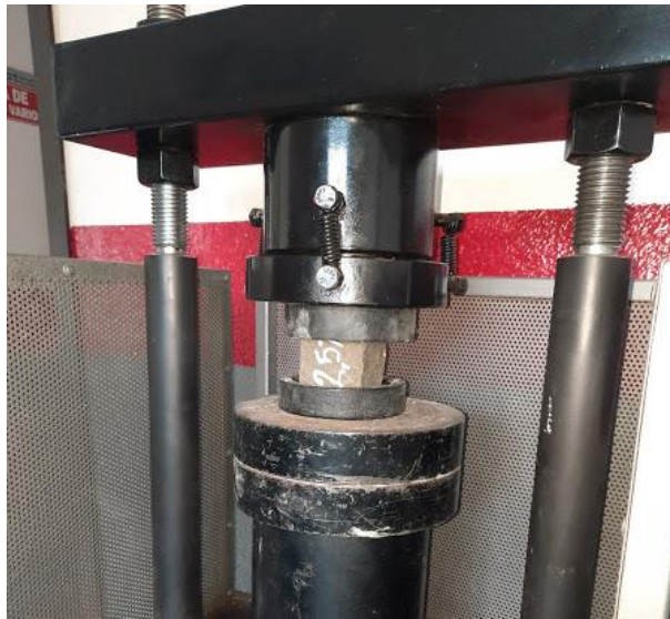
Figura 45. Ensayo resistencia a la compresión a los 7 días en cubos de mortero con 2,5% de fibras. Autores, 2021.
