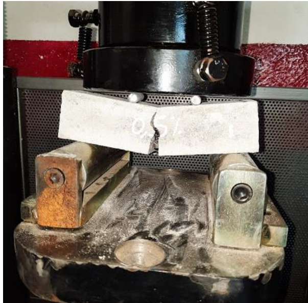
Figura 22. Viga de mortero después de resistir su máximo esfuerzo a flexión. Autores, 2021.
