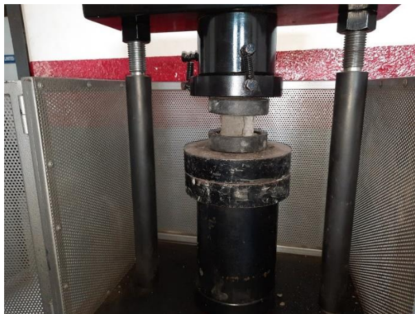
Figura 40. Ensayo resistencia a la compresión a los 7 días en cubos de mortero con 0% de fibras. Autores, 2021.
