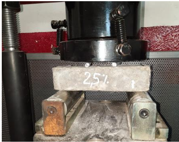
Figura 71. Ensayo resistencia a la flexión a los 28 días en vigas de mortero con 2,5% de fibras. Autores, 2021.
