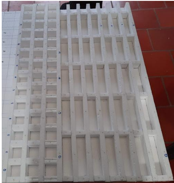
Figura 13. Moldes de icopor empleados para la fabricación de los cubos y vigas de mortero. Autores, 2021.
