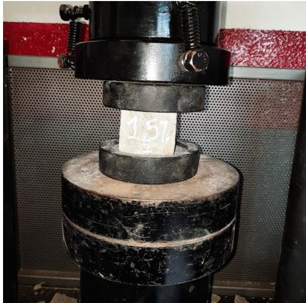
Figura 51. Ensayo resistencia a la compresión a los 28 días en cubos de mortero con 1,5% de fibras. Autores, 2021.
