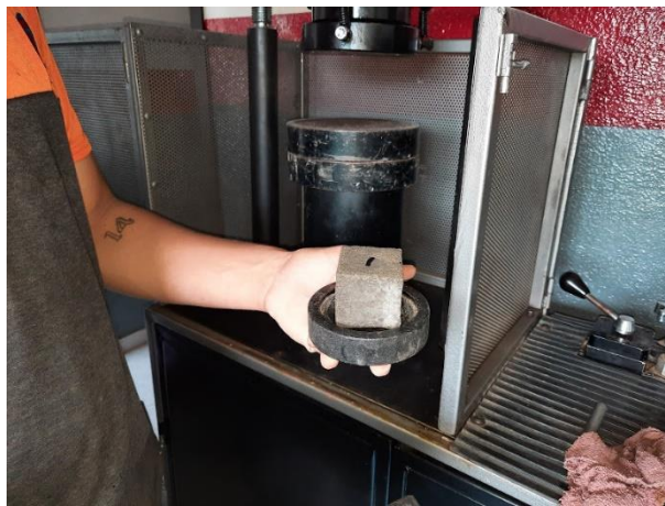
Figura 39. Ensayo resistencia a la compresión a los 7 días en cubos de mortero con 0% de fibras. Autores, 2021.
