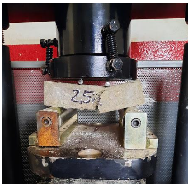
Figura 64. Ensayo resistencia a la flexión a los 14 días en vigas de mortero con 2,5% de fibras. Autores, 2021.
