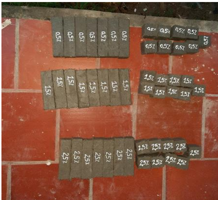
Figura 37. Marcación y numeración de las probetas de mortero. Autores, 2021.
