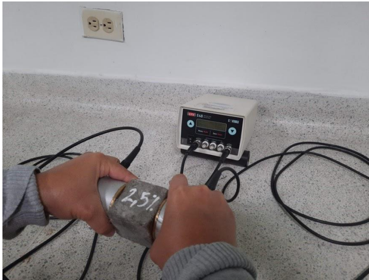
Figura 25. Ejecución del ensayo de ultrasonido en cubos de mortero para pañete. Autores, 2021.
