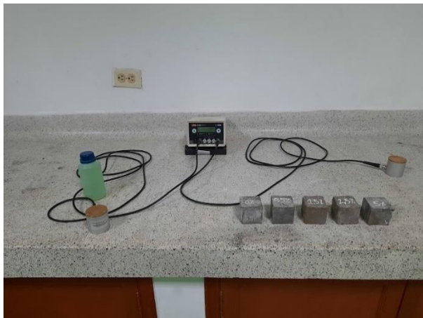
Figura 75. Cubos de morteros ensayados por ultrasonido. Autores, 2021.
