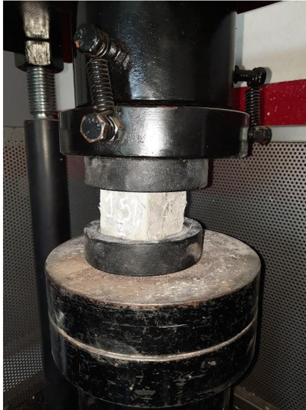
Figura 19. Cubo de mortero para pañete después de obtener su resistencia final a compresión. Autores, 2021.
