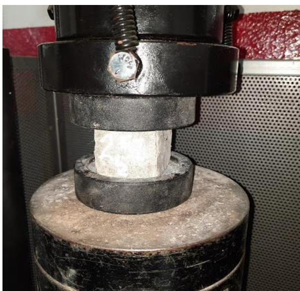
Figura 54. Ensayo resistencia a la compresión a los 28 días en cubos de mortero con 2,5% de fibras. Autores, 2021.
