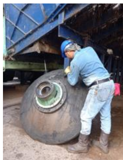
b. Desmontaje de escudos.
