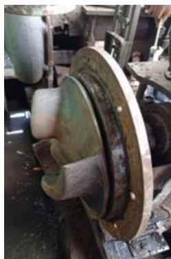
b. Desmontaje de impulsor y plato de rozamiento.
