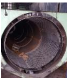
a. Corte de anillo frontal y anillo en espiral.
