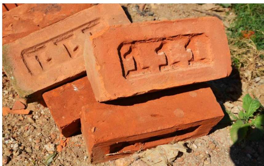
Figura 13. Ladrillos con alta resistencia a partir de residuos de construcción.
