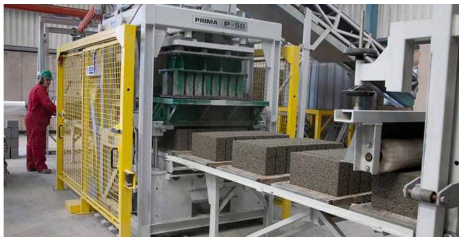
Figura 10. Prensa motorizada para el bloque de tierra comprimido y cemento.
