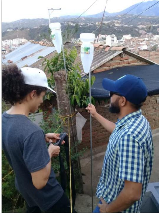
*Fotografía 5. Instalación de Pluviómetros en el barrio la Santa Cruz*
