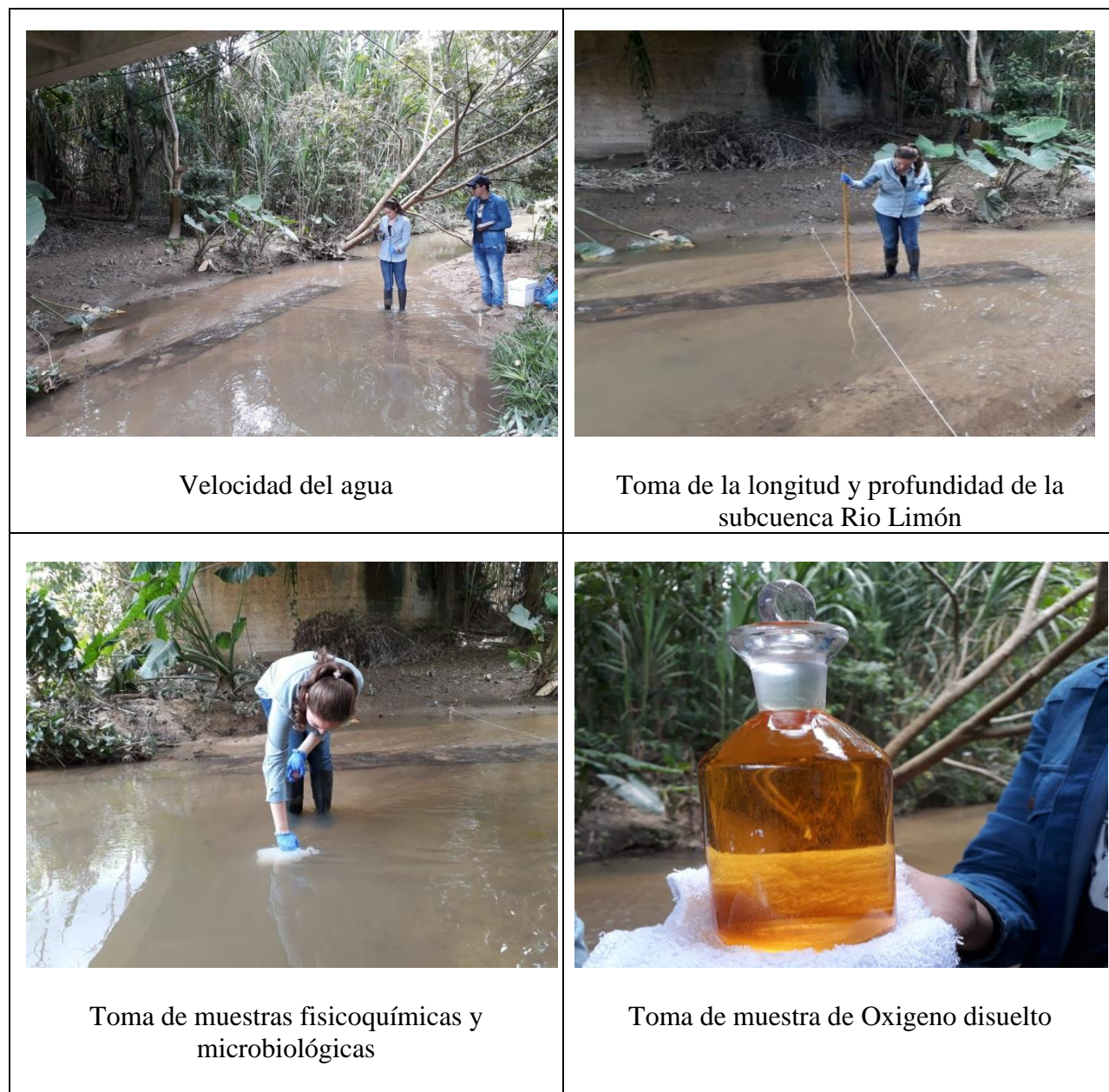
Figura 43. Toma de muestras fisicoquímicas y microbiológicas del agua y temperatura, velocidad, longitud y profundidad aguas abajo del punto de vertimiento de aguas residuales.
