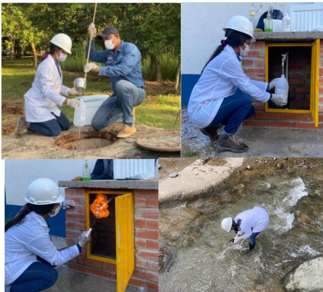
**Nota:** en las imágenes anteriores se observa la toma de muestra de agua cruda y agua potable (tanque de almacenamiento y Barrio el centro “Hidrante #3”).
