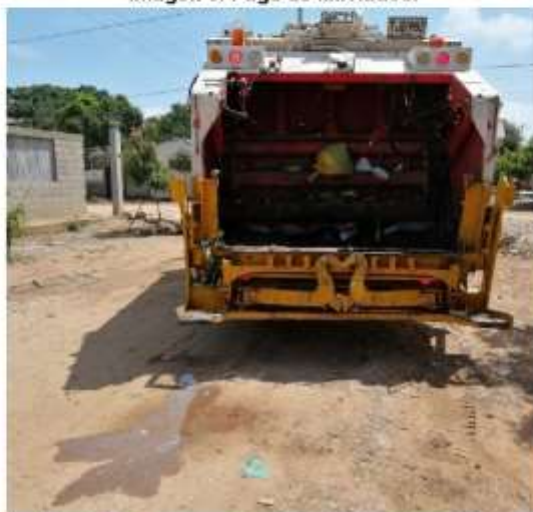
Imagen 3. Fuga de lixiviados.
