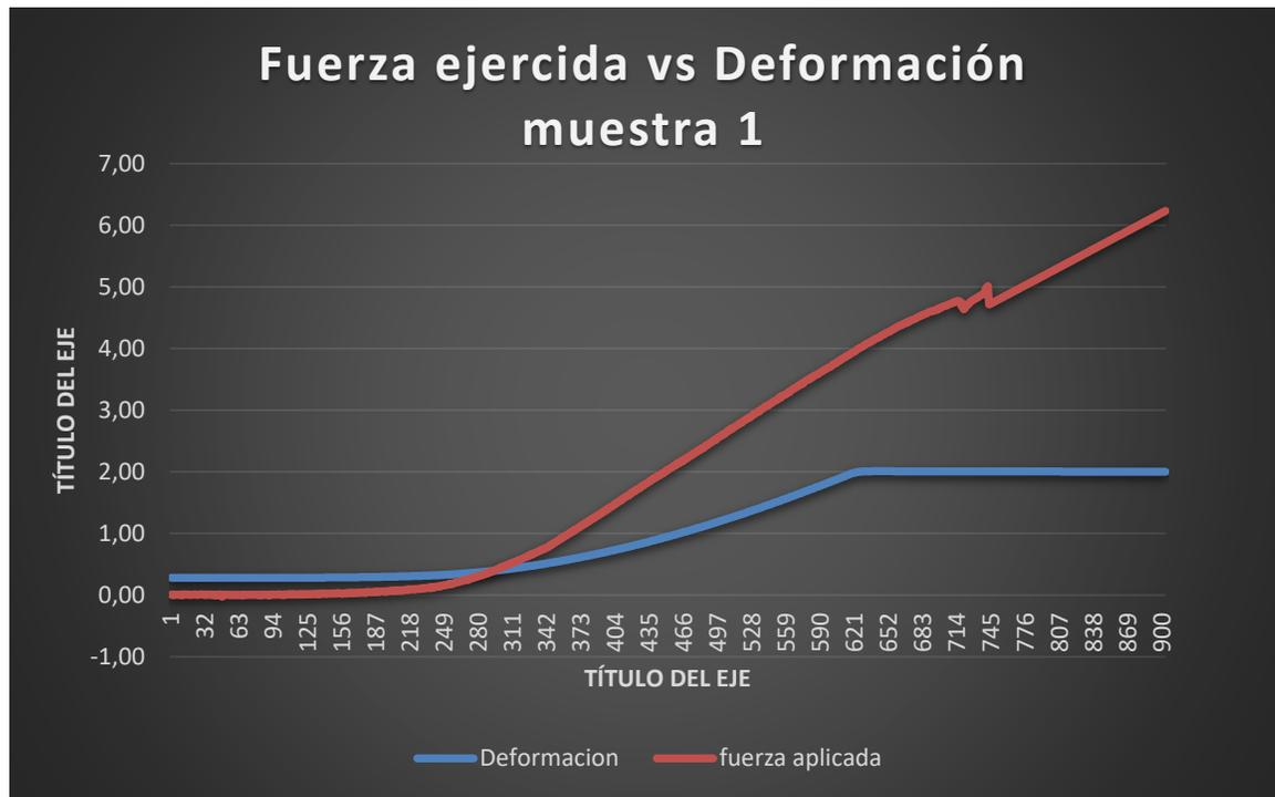
los que se calculó la deformación para esto se tomó la longitud total y la longitud inicial la cual nos permite identificar la deformación después de ser sometido a una compresión axial.
