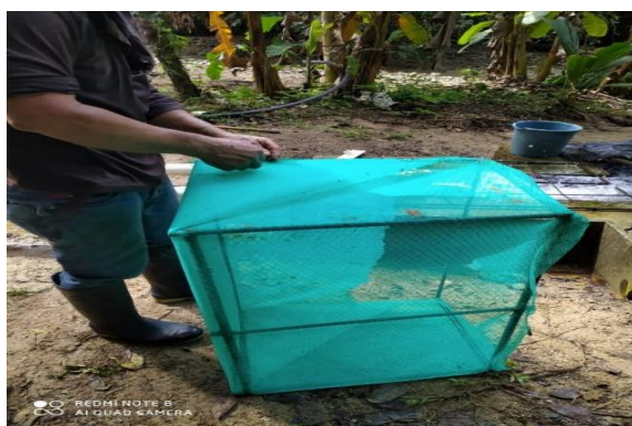
Apéndice E. Cambio de malla que retiene los sólidos y partículas de gran tamaño. Pasante.
