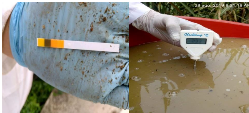
Imagen 4. Análisis in-situs de PH y temperatura de las aguas residuales del proyecto porcino. Fuente: (autores del proyecto)
