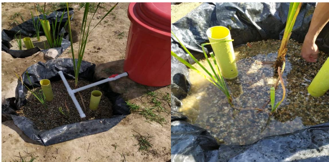
Imagen 13 , Sistema de distribución y llenado de los filtros para la adaptación de la especie typha latifolia (totora). Fuente: (Autores del proyecto)
