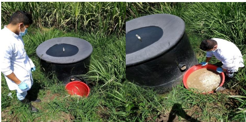
Imagen 2. Medición del caudal promedio en el punto de vertimiento utilizando el método volumétrico. Fuente: (autores del proyecto).
