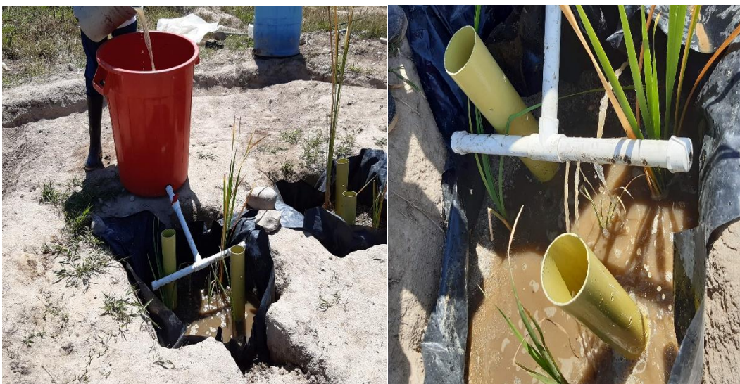
Imagen 17. Dosificación del segundo filtro en la segunda etapa del sistema piloto. Fuente (Autores del proyecto)
