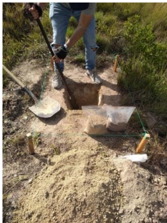
Figura 9. Excavación de la calicata (2021).
