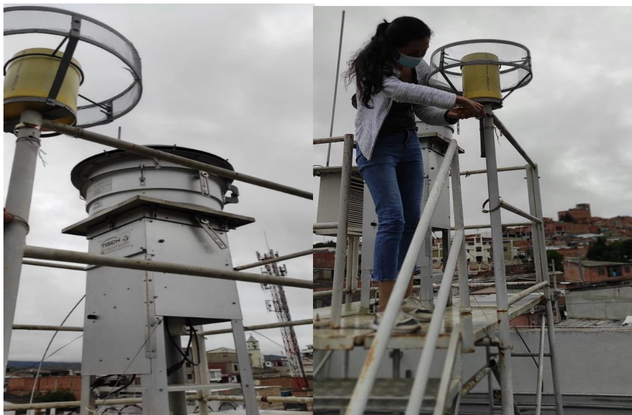
Figura 4. Montaje de captador pasivo. Fuente: Autoras
