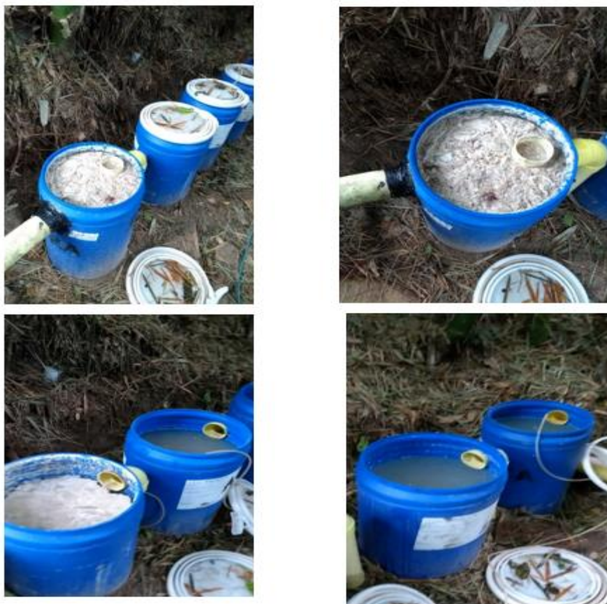
Figura 18. Conexión y puesta en marcha del sistema piloto de proceso biológico.
