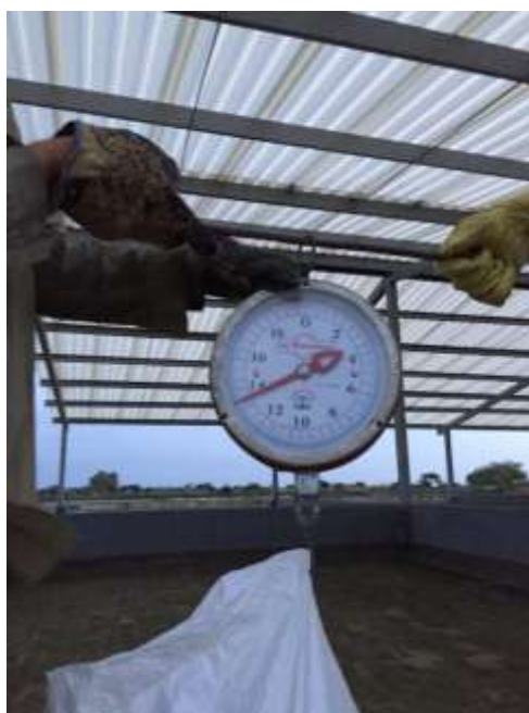
Figura 34. Realización del peso de los lodos en los lechos de la planta
