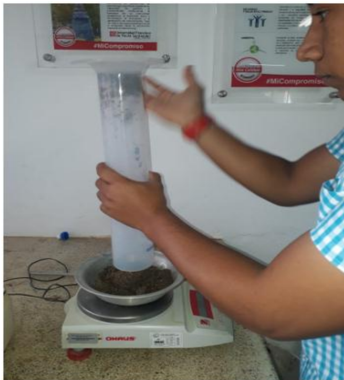
Apéndice G. Medición del peso volumen de la muestra de arena húmeda.
