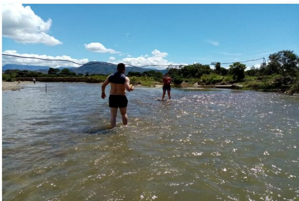
Apéndice H. Medición de distancias para el cálculo de caudal.
