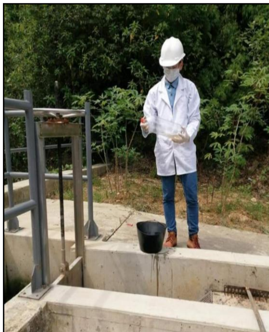
Toma de muestra en la Entrada de la planta
