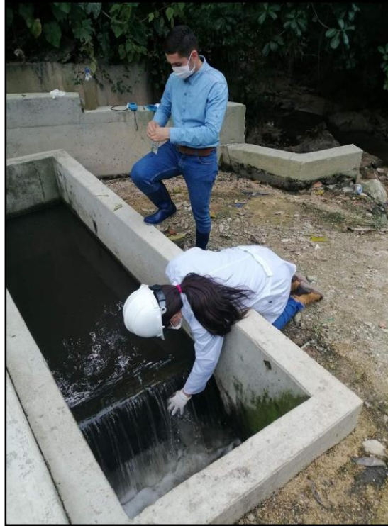
Toma de muestra en la salida de Planta de Tratamiento
