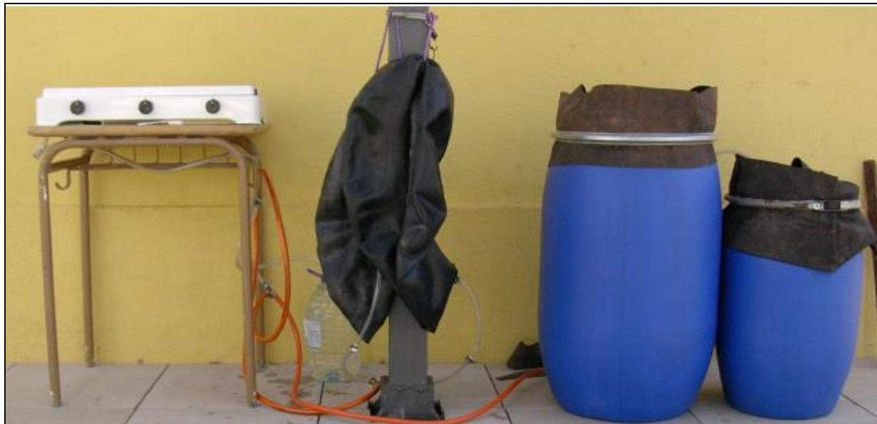
Figura 13. Prototipo del sistema a construir. Fuente: Panel del biogás, Servicios manufactureros. Recuperado de: http://www.oas.org/dsd/Energy/Documents/SimposioG/3%20Panel%20I%20Biogas.pdf
