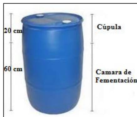
Figura 11. Distribución del tanque para el prototipo del digestor. Autores, 2020.
