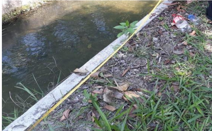
Figura 40. Medición del Caudal del minidistrito de riego Río Frío.
