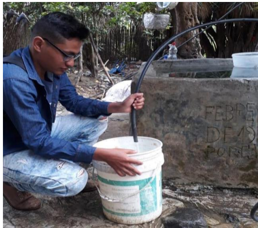
Figura 49. Medición del caudal al sistema de abastecimiento Rural Capitanlargo.
