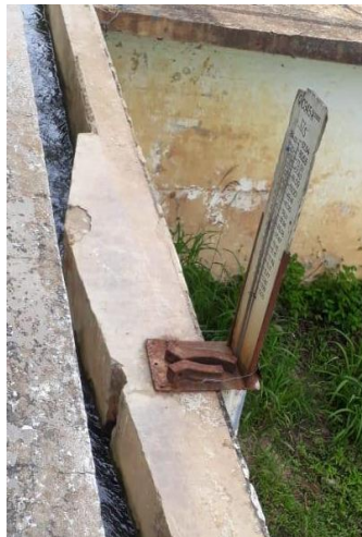
Figura 51. Método de la regla, utilizado para la medición de caudal de la PTAP – Casa de Teja. Fuente. Autor del proyecto (2019).
